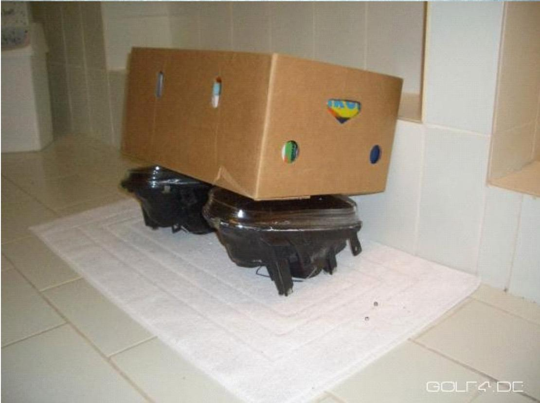
Nach einem Tag sollte alles soweit ausgehärtet sein, dass man die Scheinwerfer verbauen kann. Vorher noch einen Dichtigkeitstest machen und mal unter den Wasserkran halten. Kabelbaum, Stellmotoren und Leuchtmittel einfügen.
