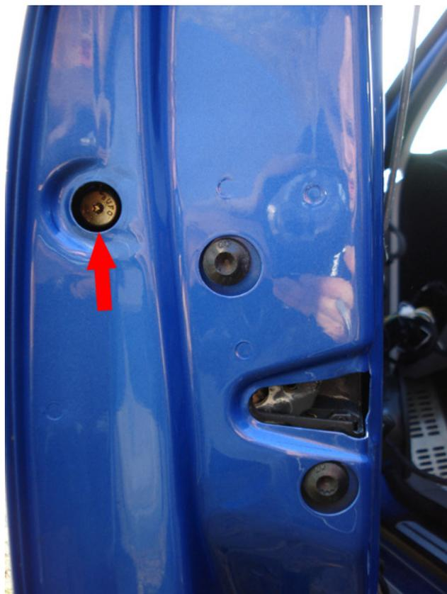
**Mit dieser Schraube wird der Schließzylinder arretiert.
