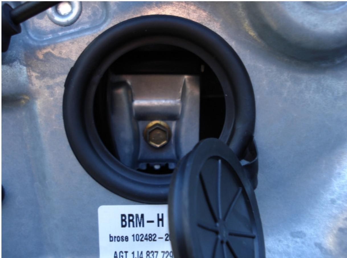
**Jetzt kann man die Fensterscheibe nach oben schieben und mit dem Paketklebeband am besten mit 3 Punkten fixieren.**
