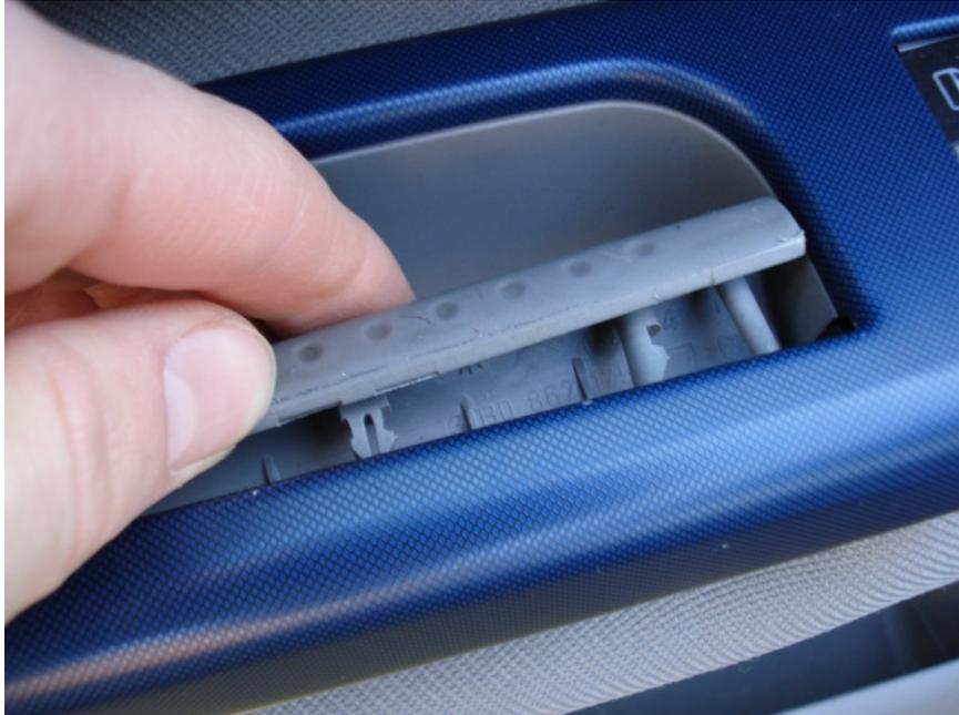
**Jetzt kann man die Griffschale nach oben ausclipsen. Dies geht beim ersten Mal ein wenig schwer, ggf. auch hier mit einem Schlitzschraubendreher nachhelfen und aufpassen, dass man nichts verkratzt (Tipp: Tuch um den Schraubendreher legen)**
