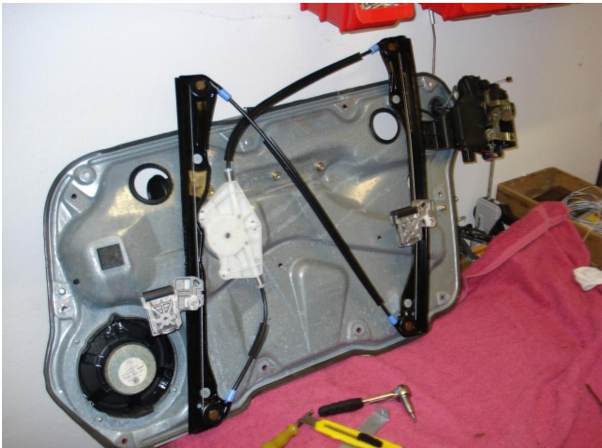
**Hier noch mal ein Bild der beiden Halter. Der Verlauf der Seile (oben/unten) muss man sich merken, bzw. fotografieren.**
