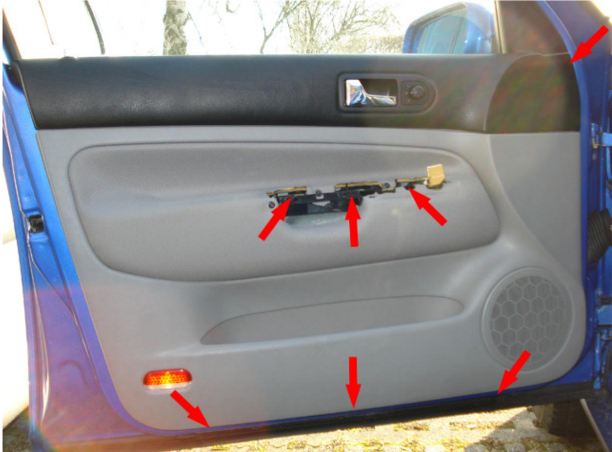
**Jetzt kann man die Türverkleidung abclipsen. Dazu mit einem heftigem Ruck die Verkleidung zu sich reißen. Am besten fängt man in einer Ecke an. Man kann die Verkleidung auch mit einem Schraubenzieher raushebeln, dazu den Schraubendreher bitte wieder mit einem Tuch umwickeln.**
