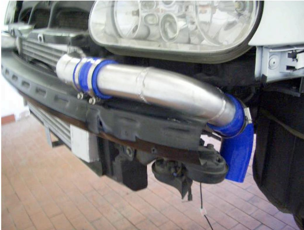
8. Auf der Beifahrerseite wird nun das Druckrohr mit Sensor montiert (außer AGU), das Rohr passt nur in einer Position. Der Sensor wird mit den Schrauben des Serien LLK befestigt (Blechtreibschrauben).
