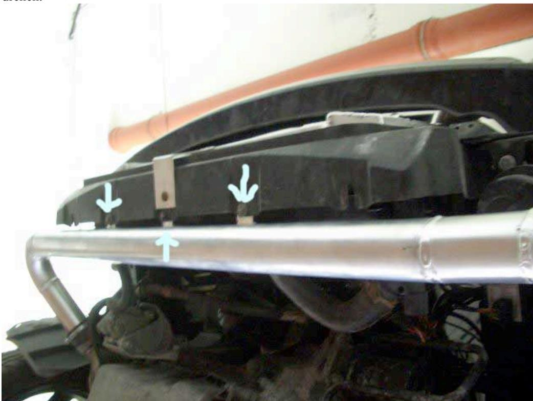
Das eine Ende wird nun in den 90 Grad Bogen gesteckt und mit einer Schelle gesichert, das andere Ende wird im original „Pfannkuchenrohr“, im Radhaus befestigt. Wenn alles richtig montiert ist sollte es so aussehen.
