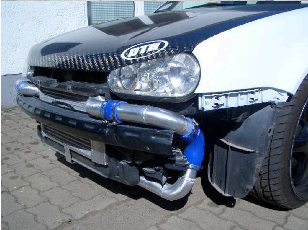
Zum Schluss werden noch die geclipten Verstärkungen der Scheinwerferreinigungsanlage hinter der Stoßstange entfernt und die Stoßstange kann wieder montiert werden.
