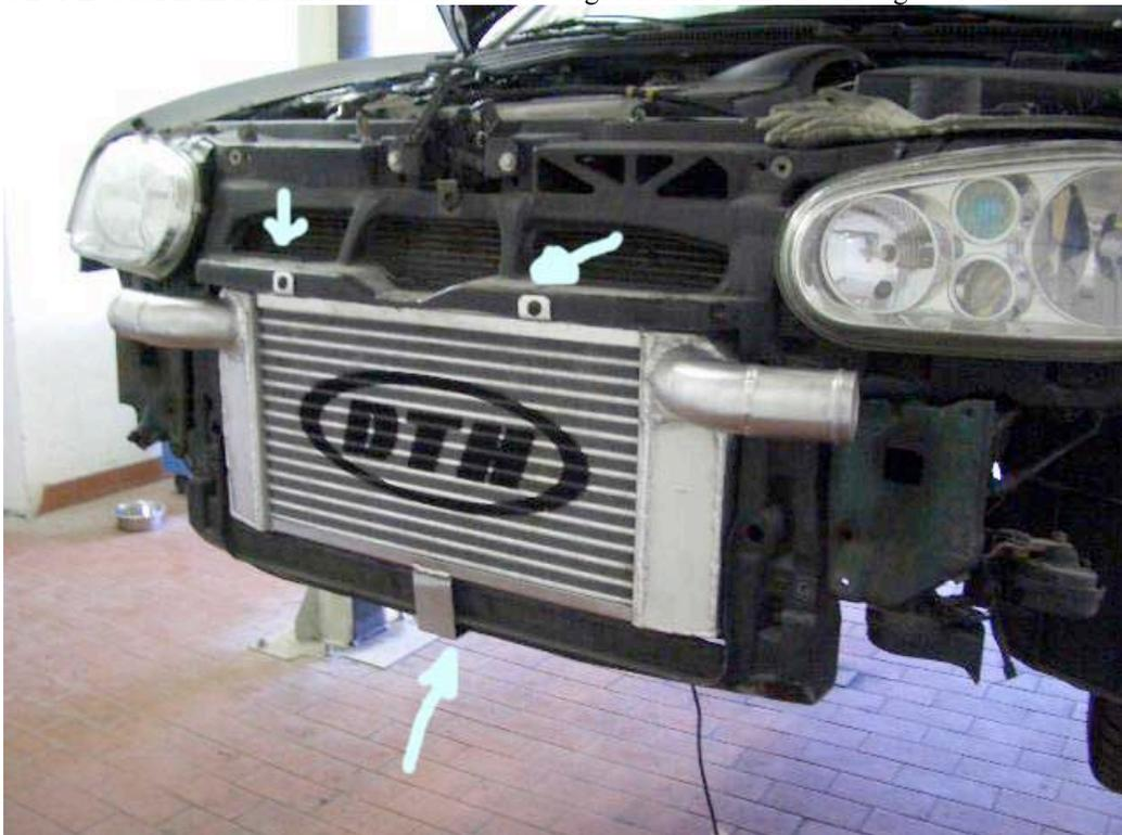
7. Der Frontquerträger wird nun endgültig montiert. Als nächstes wird das mitgelieferte Ladeluftrohr eingesetzt dabei zeigt die längere, der beiden Seiten zum LLK. Der 90 Grad Bogen wird wie auf dem Bild zu sehen ist angebracht, das Signalhorn muss nicht dafür entfernt werden.
