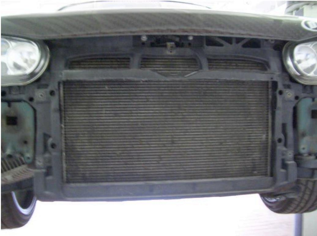
3. Der Ladeluftkühler kann nun das Erste mal Probe wohnen. Setzen sie den LLK ein und montieren den Frontquerträger davor.
