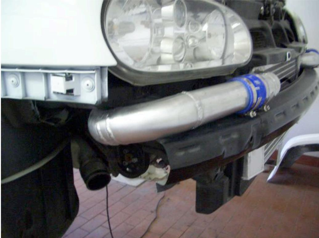
9. Zu guter Letzt kommt noch die Montage des großen Ladeluftrohres. Das Rohr an folgenden Punkten am Frontmittelteil befestigt (siehe Foto) dazu die angebrachten Alulaschen unter dem Plastik positionieren und durchbohren / vorbohren. Dann die Blechtreibschrauben durch die vorgebohrten Laschen ins Plastikgehäuse drehen.
