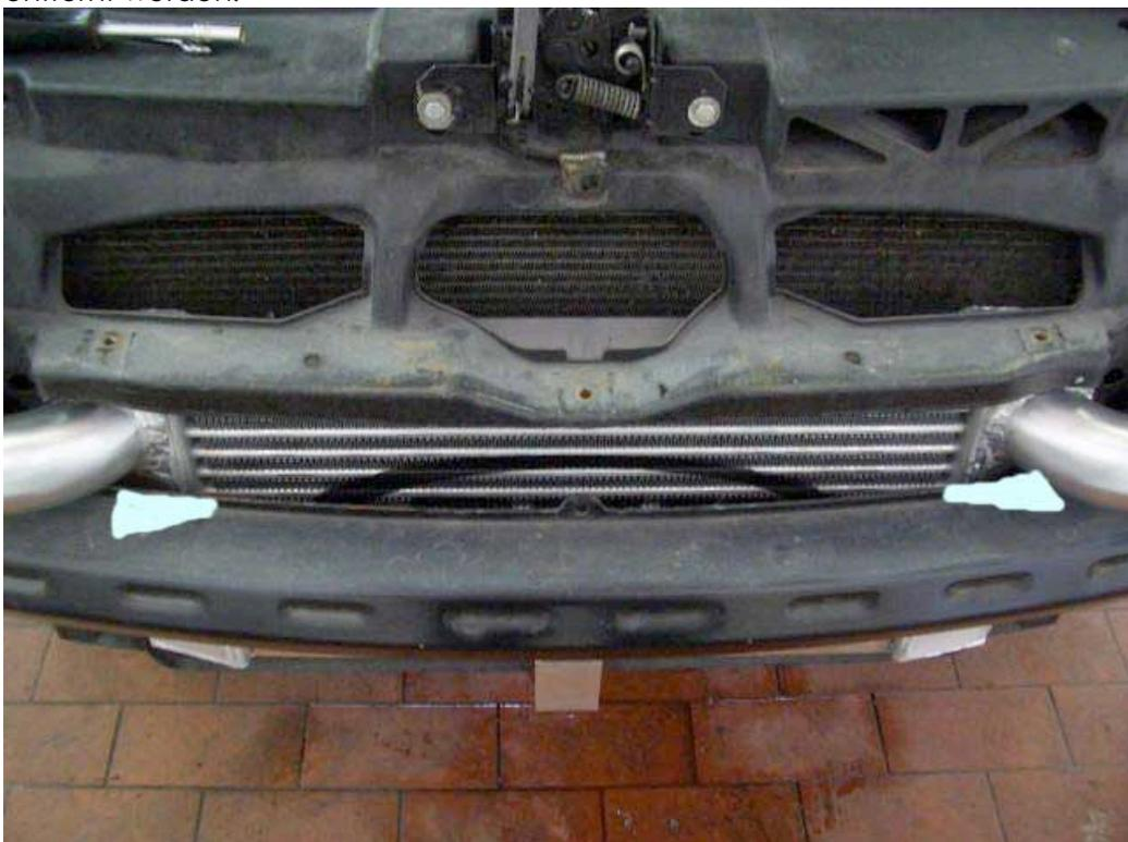
5. Um die Verrohrung montieren zu können müssen nun noch bei allen Modellen zwei kleine Streifen vom äußeren Rand des Trägers entfernt werden.
