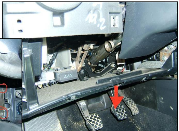
Abb. 24 Entfernen der unteren Verkleidung
