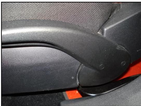
Abb. 7 Verschraubung des Höhenhebels
