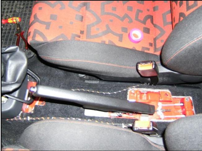
**Abb. 32 Kabelverlegung unter der Mittelkonsole**
