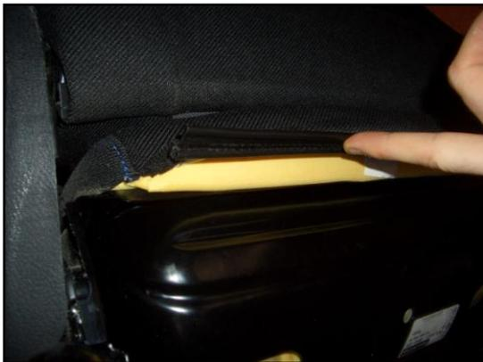
Abb. 8 Klemmleiste hinten
