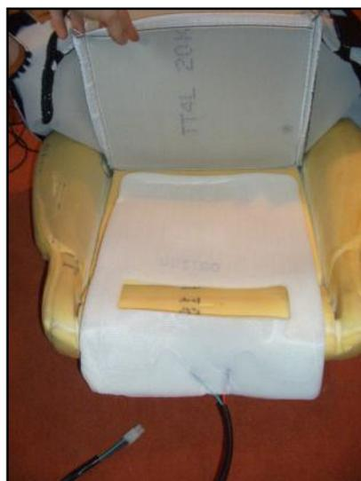
Abb. 10 Heizmatte auf Polster, die Längskabel müssen in die Vertiefung gesteckt werden (dort geht nachher der Draht drüber zur Befestigung des Stoffes)
