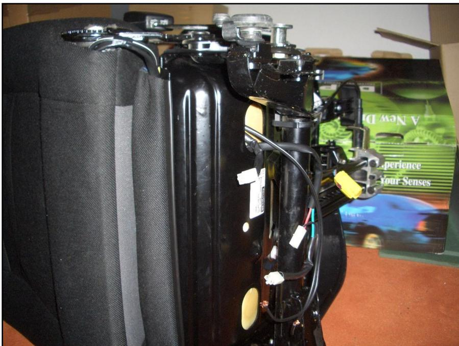
Dann hat man noch 3 Kontakte die immer belegt werden müssen: Heizung Plus (im Bild oben dunkelblau), Sensor Plus (Im Bild oben Türkis), Masse (braun). Dazu werden die Kabel in die Kontakte gequetscht und in das Steckergehäuse eingesetzt werden. Die Reihenfolge sollte man sich merken, weil ja später die Buchse entsprechend belegt werden muss.
