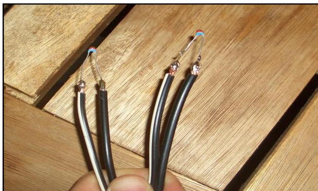
Abb. 2 verlötete Sensoren ohne Schrumpfschlauch
