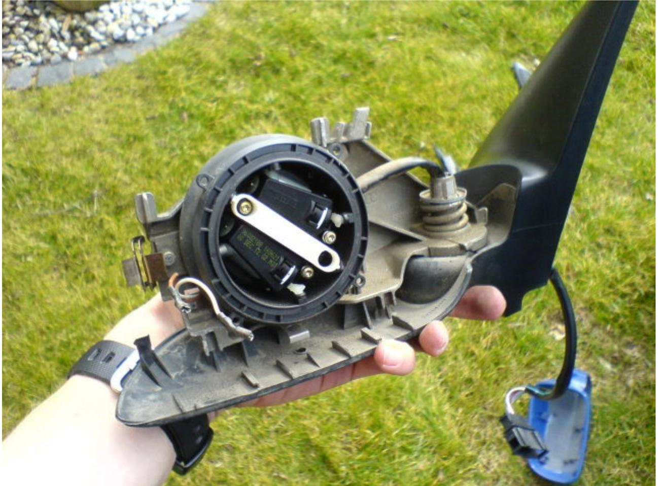
Punkt 3: Elektrische Spiegelverstellung demonstrieren (3 Torx Schrauben + Kabel für Stromzufuhr)
