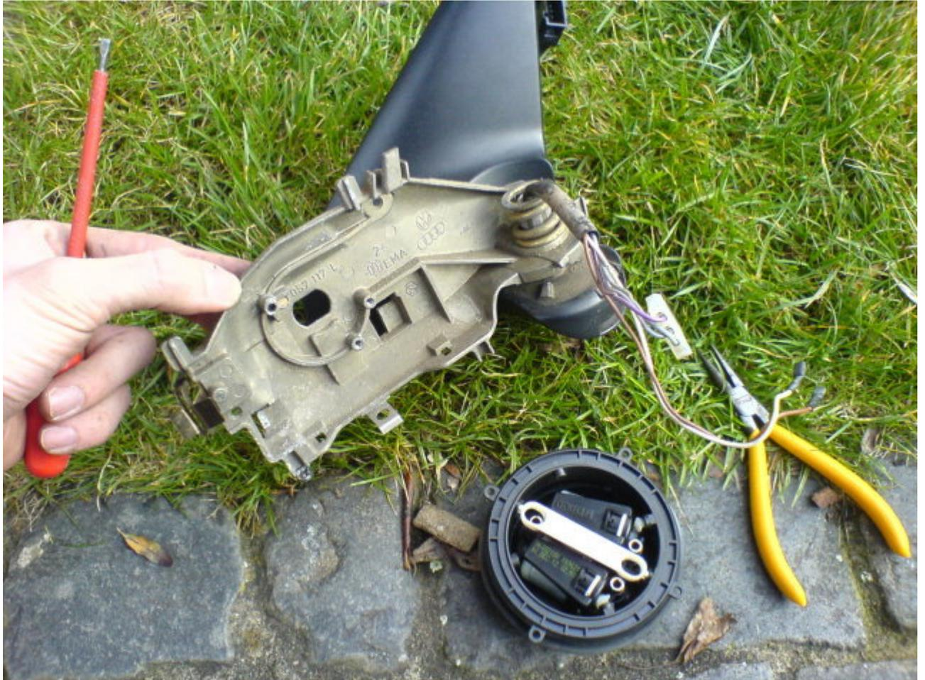
Punkt 4: Sicherungsring demontieren
