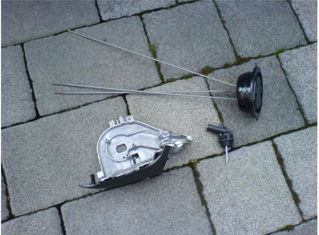
Punkt 6: den Alu-Guss träger vom Lupo wird nun auf das vorhandene Golf 4 Spiegeldreieck gesetzt und mit der Feder + neuem Sicherungsring befestigt. Vorher müssen natürlich alle Drähte dort hindurch gezogen werden. Elektrische Spiegelverstellung und das Glas können nun wieder montiert werden. Also alles in umgekehrter reihenfolge wieder zusammenbauen.
