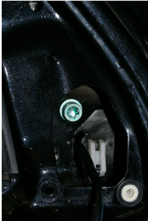
Eventuell die Dichtung erneuern und den neuen Spiegel montieren. Der Hochtöner kann wieder montiert werden.
