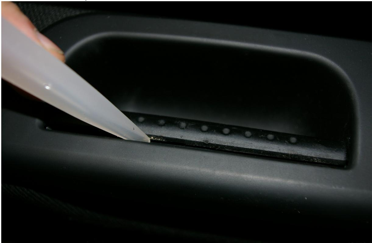
Danach kann man das komplette Fensterheber Bedienteil nach oben hin entfernt werden.
