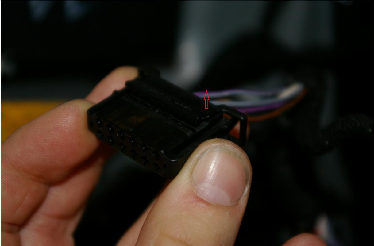
**Pin 1 vom Spiegelstecker** wird mit **Pin 13 des Steckers am Türsteuergerät** verbunden, und **Pin 3 vom Spiegelstecker** mit **Pin 9 des Steckers am Türsteuergerät**.
