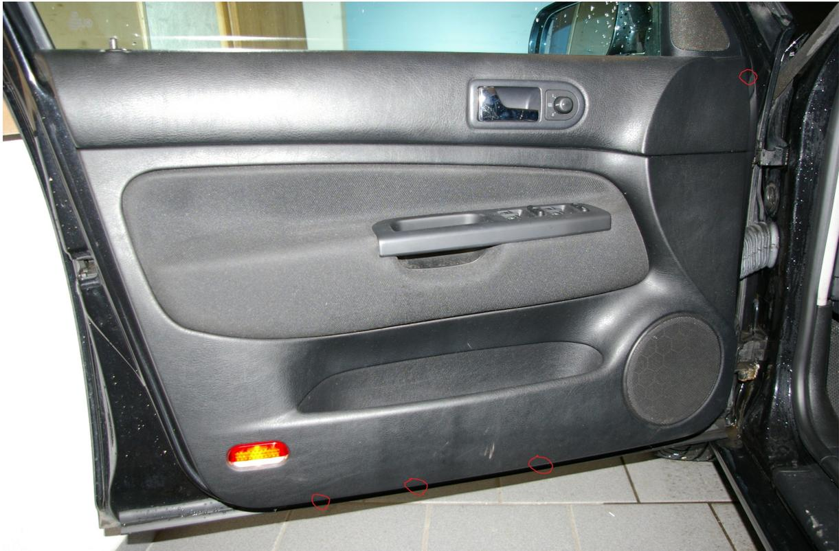
Ebenso muss am Türgriff die Innere Blende ausgeklipst werden. Dazu mit einem Montagekeil (bzw. Schraubendreher) verwenden.
