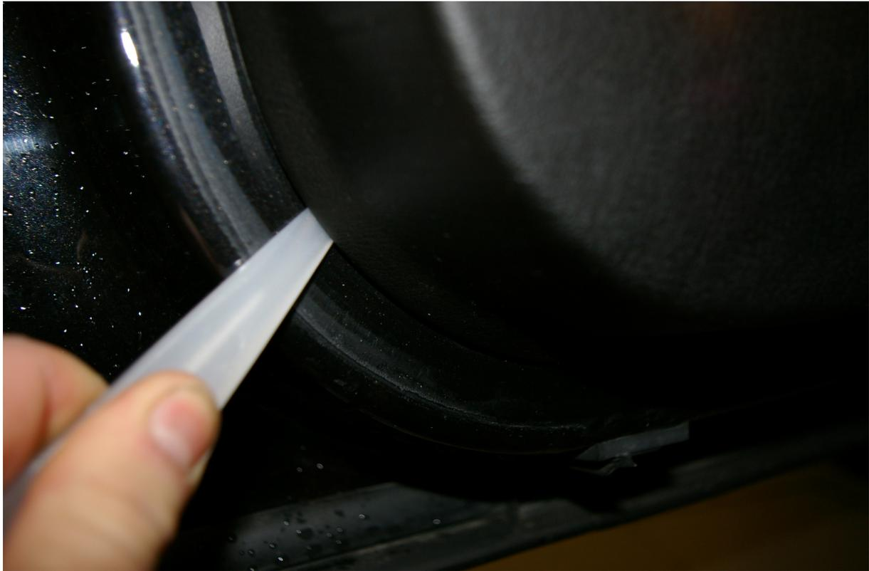
Wenn diese Rundherum gelöst wurde kann diese nach oben hin weggeschoben werden. Alle elektrischen Anschlüsse abstecken, und den Bautenzug beim Türöffner aushängen. Sofern alles lose ist, kann diese beiseite genommen werden. Nun kann gleich der neue Spiegelschalter verbaut werden. Der alte ist nur gesteckt.
