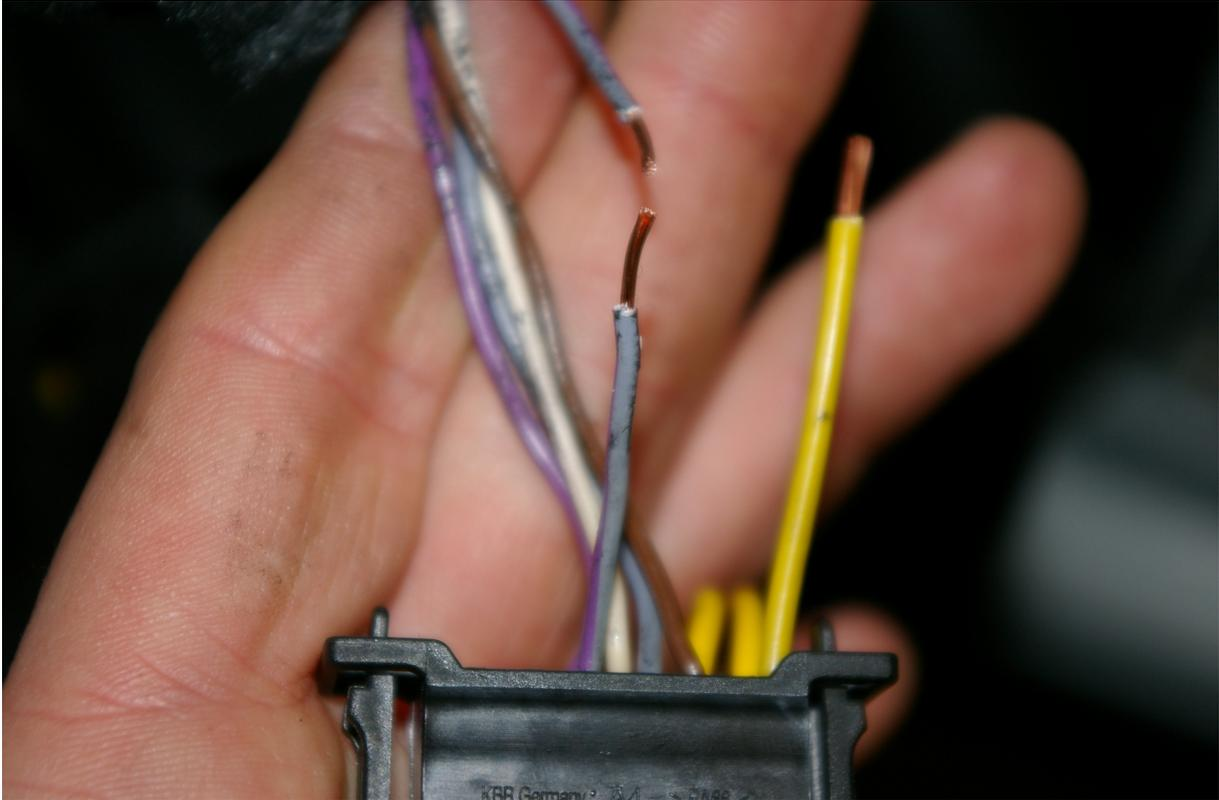
**Pin 1 vom Spiegelstecker** wird mit **Pin 16 des Steckers am Türsteuergerät** verbunden, und **Pin 3 vom Spiegelstecker** mit **Pin 26 des Steckers am Türsteuergerät**.
