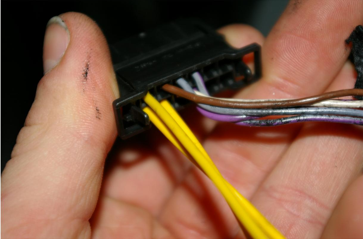
Dann das Kabel von **Pin 2** mit dem Kabel von **Pin 8 des selben Steckers** verbinden.
