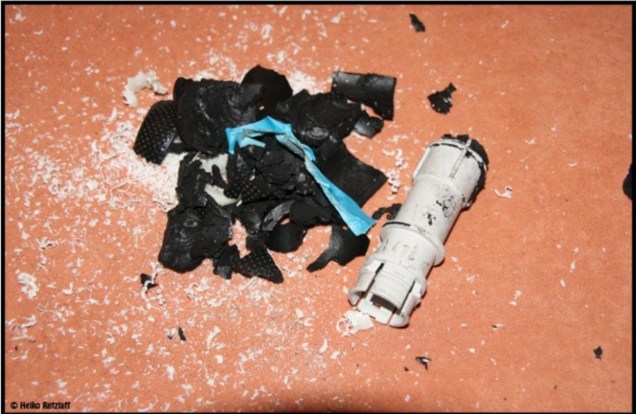
Das ist der ganze Müll der entsteht nachdem man beide Schaltknäufe vom Kunststoffgestänge befreit hat.
