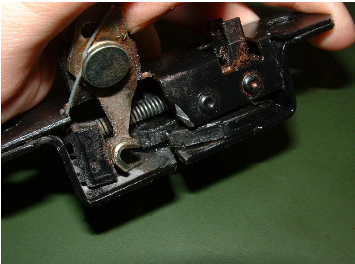
Dann mit Pressluft die Späne und den Staub rausblasen und schön mit Nähmaschinenöl einölen. Restliches Öl rausschleudern oder am Rand abtupfen.
