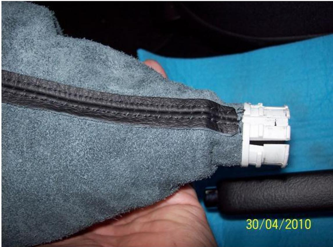
**Sobald der schwarze Klemmring runter ist, kann der alte Sack leicht über die weiße Passung abgezogen werden. Der neue Sack kann genauso einfach über die Passung draufgezogen werden. Dabei ist auf die Lage der Nähte zu achten (müssen links und rechts verlaufen) und darauf, dass der neue Sack bis an den Kragen der weißen Passung herangeführt wird, damit der schwarze Klemmring den neuen Sack auch festhalten kann. Das Leder darf aber nicht über den Kragen der Passung hinausstehen.**
