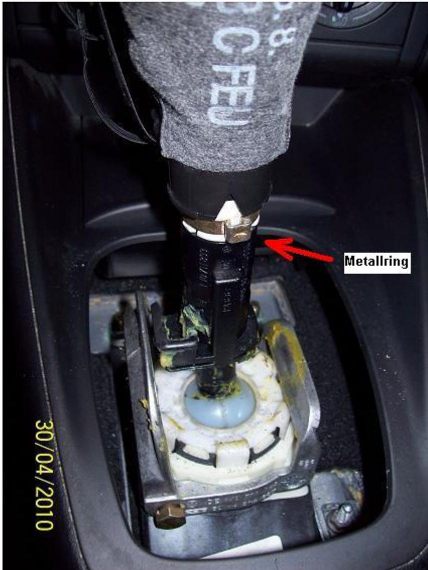
Den "alten Sack" so weit nach oben ziehen, bis der Metallring freiliegt, der den Knauf am Schalthebel festhält.
