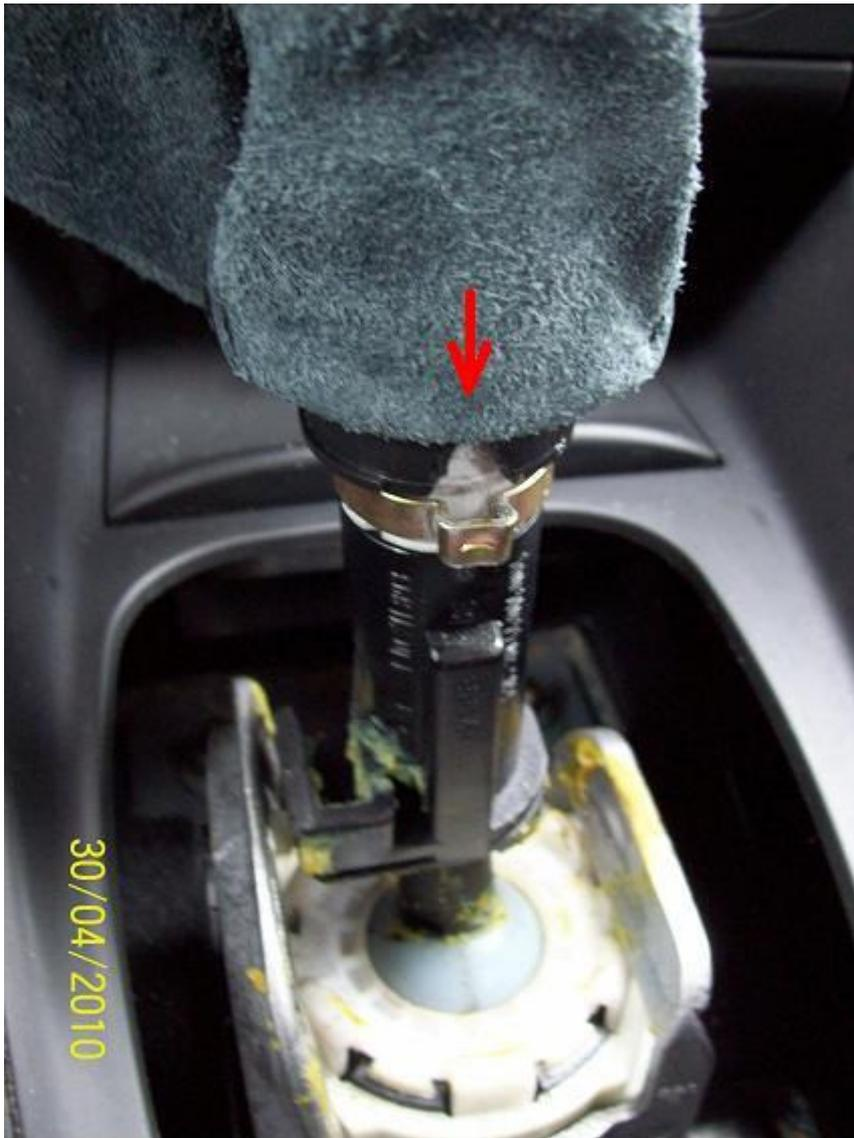
**Dann den Knauf samt neuem Schaltsack wieder auf den Schalthebel stecken (rastet mit einem satten Klack wieder ein). Auf richtige Position der Gananzeige achten.**
