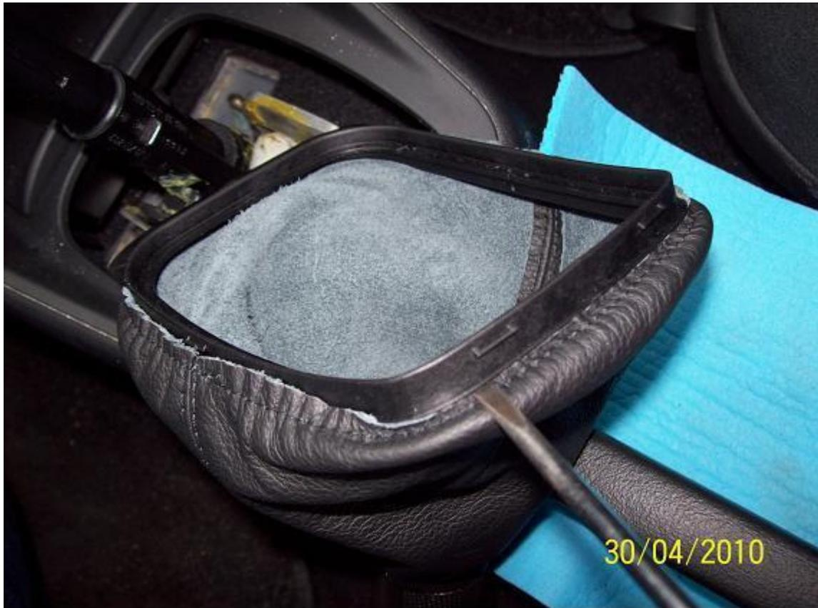
Für das Einklemmen des neuen Schaltsacks in den unteren Spannrahmen habe ich einen alten stumpfen Schraubendreher genommen, um das Leder nicht zu beschädigen. Im Bereich der seitlichen Nähte zeigte sich das dicke Leder recht unwillig. Dort drückte es sich leicht wieder raus. Etwas mehr Zugkraft im Gummi wäre wünschenswert gewesen.
