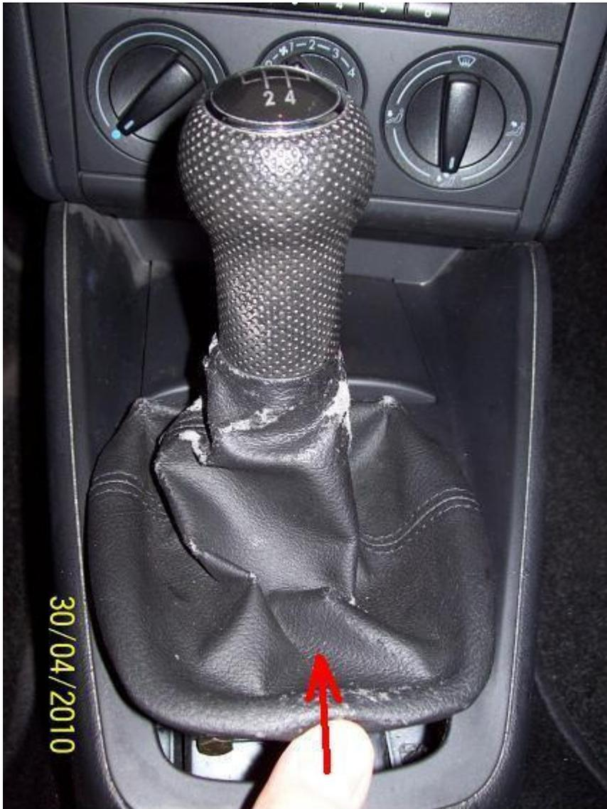
**Den unteren Spannrahmen mit dem Daumen leicht in Richtung Schalthebel drücken und nach oben aushaken.**
