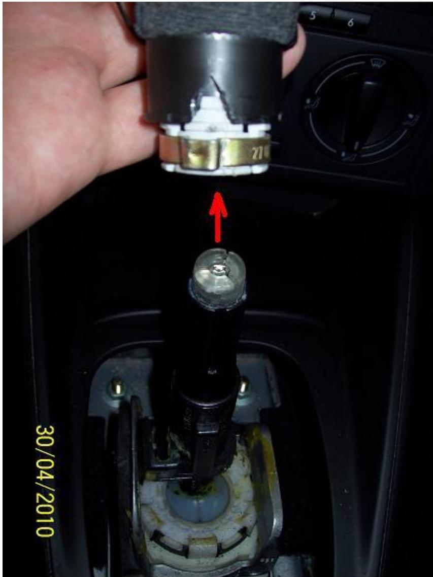
**Sobald der Metallring lose ist, kann der Knauf mit etwas Schmalles gerade nach oben abgezogen werden. Keine Angst, das Getriebe bleibt nicht dran hängen.**
