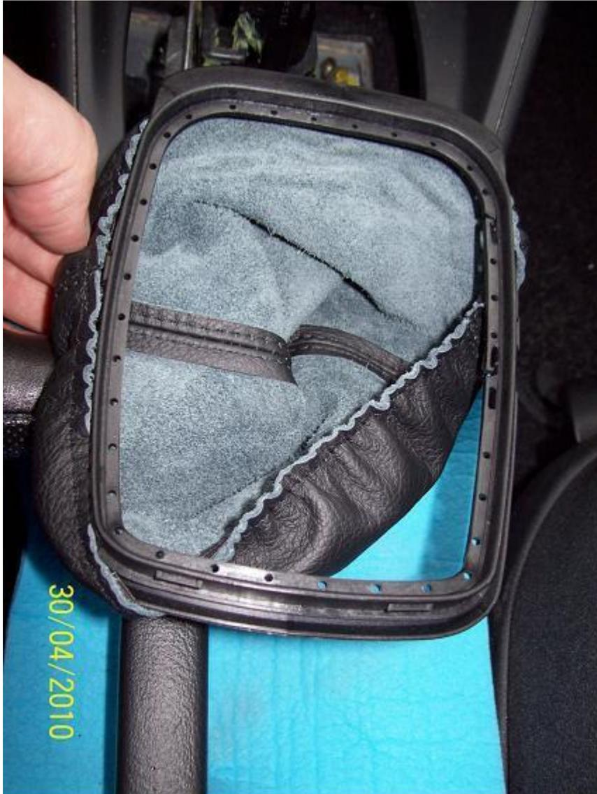
**Neuen Schaltsack auf den unteren Spannrahmen ziehen.**
