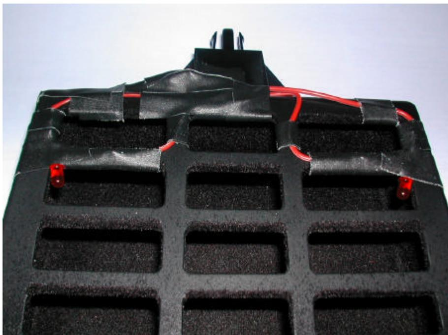
6. Alles wieder einbauen und die LEDs anschließen: Dazu vom Lichtschalten am Innenlichtkabel (blau/grau) via Lüsterklemme den Strom holen (siehe dazu auch die Einbauanleitung für die Passat W8-Innenleuchte). Masse gibt's auch am Lichtschalter (braun).
