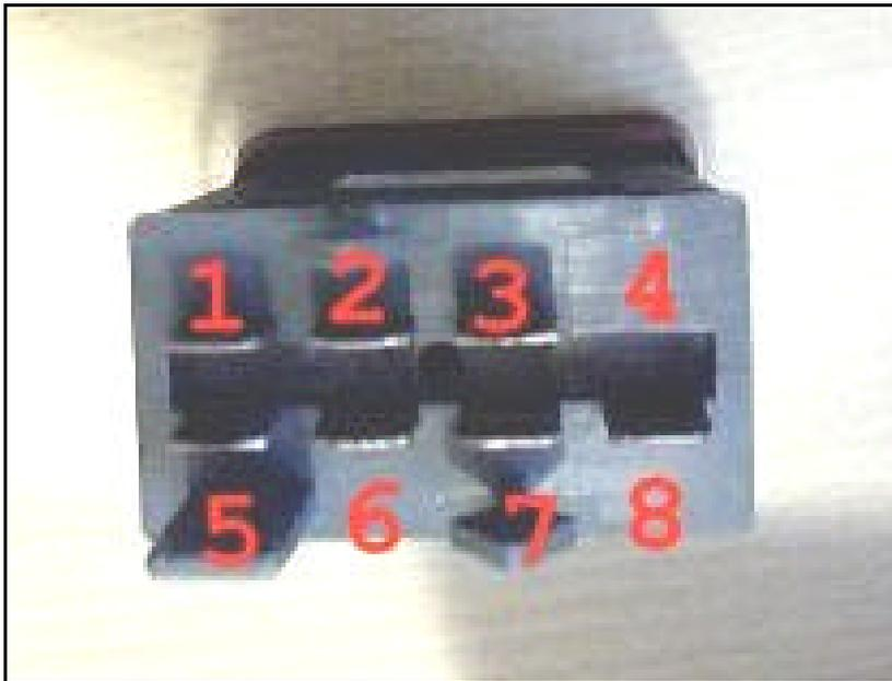
Wenn man das Warnblinkerrelais von hinten sieht, dann sind dort 7 Anschlusskontakte (siehe beide Bilder), oben 3 und unten 4 Stück. Auf dem Bild (oben) sind sie durchnummeriert.
