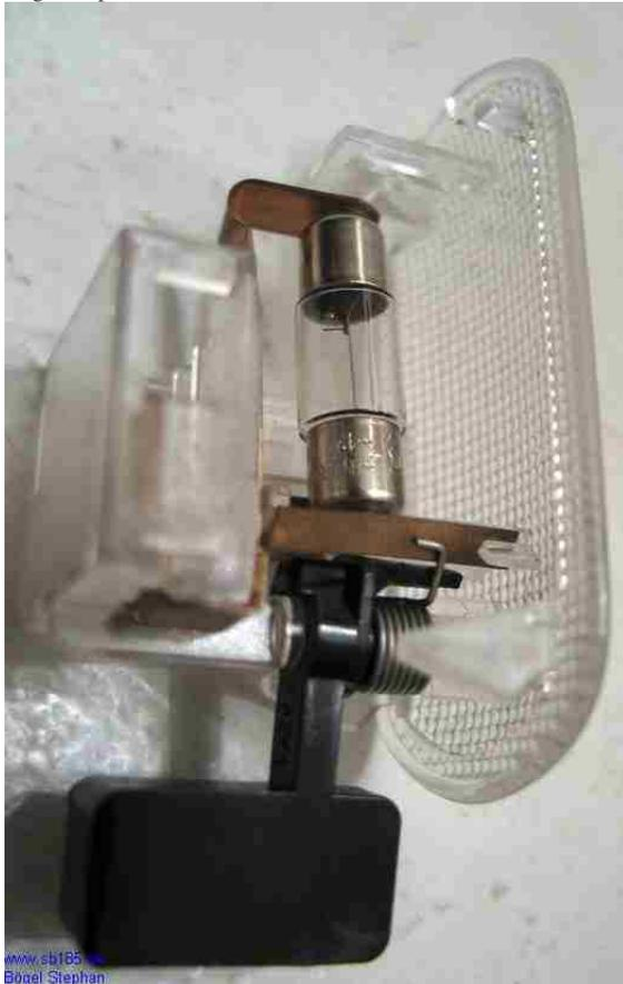
Die Feder muss ziemlich stark gespannt werden. Man braucht etwas Geduld und Fingerspitzengefühl weil einem die Feder immer ins Auge springen will. ☺
