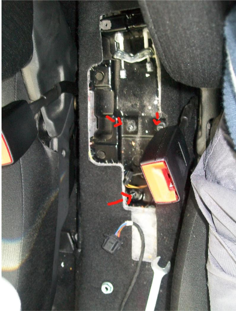
**Die Handbremse ist mit 13er Muttern an folgenden Punkten verschraubt.**
