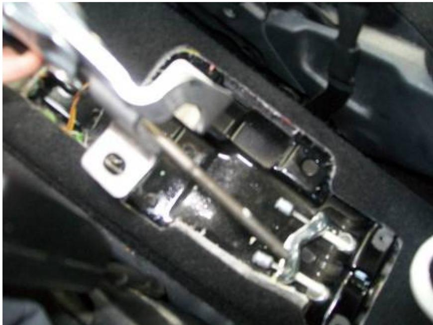
**Jetzt muss das Handbremsseil ausgehängen werden.
