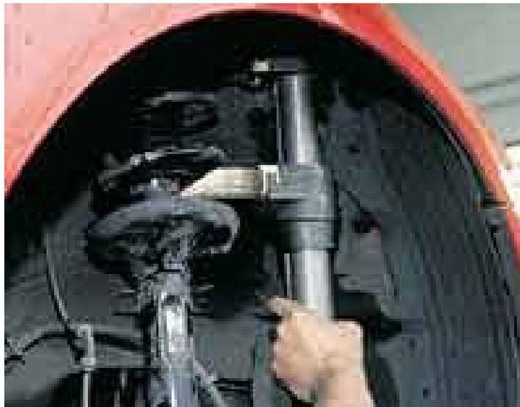
Einbau geschieht in umgekehrter Reihenfolge - auch hier wieder das Problem das Federbein in das Radlagergehäuse zu bekommen weil ca. 20mm fehlen. Die Lösungsmöglichkeiten dazu wurden oben schon erwähnt.
