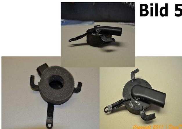
Wenn alles 100% ig passt nehmen wir den Ausströmer, dieser muss noch etwas bearbeitet werden. Bild 5 zeigt ihn fertig bearbeitet. Ich habe einfach die abstehenden Haltepunkt mit dem Bastelmesser und dem Seitenschneider geglättet und dann mit dem Heißluftfön an die Form des Handschuhfaches angepasst.
