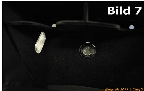
Jetzt kommt die Frage, wo man den Luftschlauch anschließen möchte. Es soll eine Vorbereitung im Luftkanal für die Beifahrerluftdüse geben, dann funktioniert das Handschuhfach allerdings nur, wenn diese Luftdüse geschlossen und die Zentralklappensteuerung auf eben diese Düse gestellt ist...
