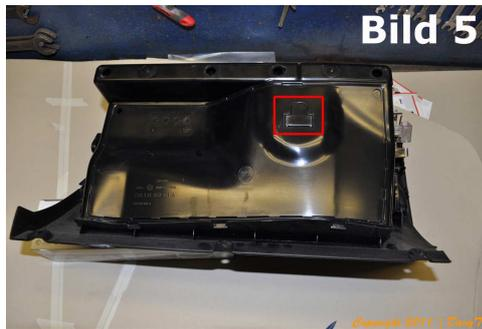
Also wir halten das Ventil erst einmal an die perforierte Stelle ( Bild 5 ) an der Rückseite des Handschuhfaches um 100% sicher zu stellen, dass das auch wirklich passt.
