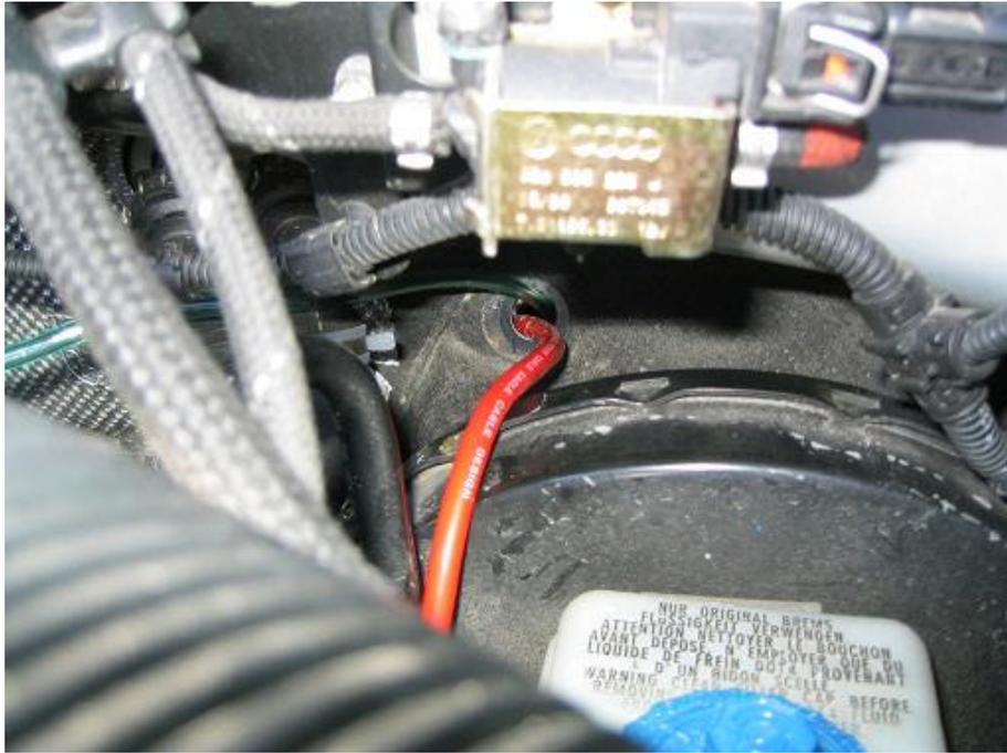
2. Alles anschließen: Beleuchtung der Ladedruckanzeige anschließen (einfach den Strom bei vorhandenen Bora-Lüftungsdüsen dort abzapfen oder eben vom Lichtschalter holen). Anschließend dann den Druckschlauch an der Ladedruckanzeige anschrauben. Jetzt muss man nur noch den Rahmen in die Mittelkonsole einklipsen.
