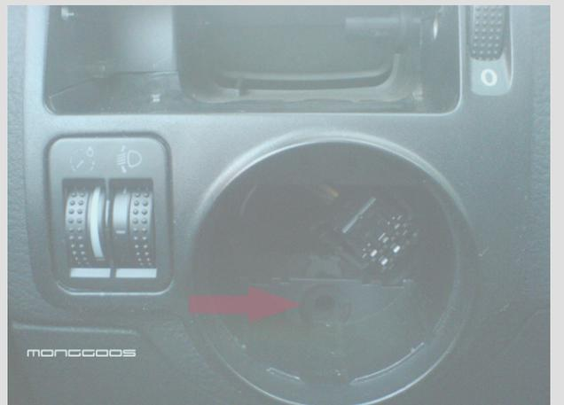
Im nächsten Schritt setzt man den Montagerahmen der neuen Lüftungsdüse ein und kann diesen verschrauben. Um die spätere Kabelmontage und das Einsetzen der Lüftungsdüse zu vereinfachen ist es besser die Verkleidung am Sicherungskasten zu entfernen. Nun kann man die neue Lüftungsdüse einklipsen, man sollte vorher aber auch schauen das der Kabel zugänglich ist. Nun kann auch der Lichtschalter wieder rein und kann zum testen der Beleuchtung ganz hilfreich sein.
