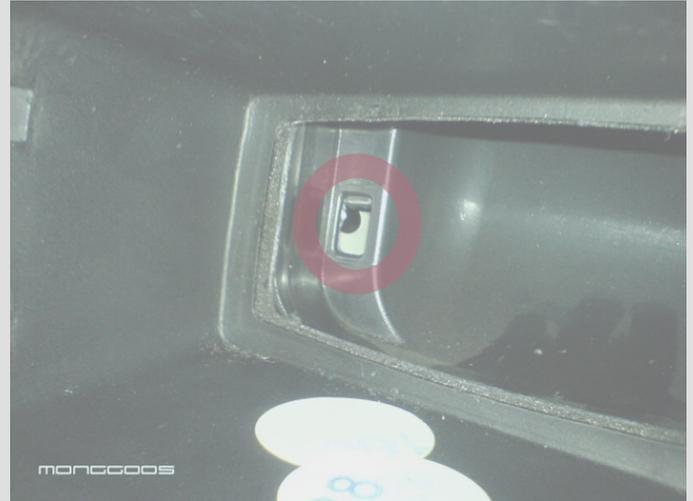
Hat man nun die rechte Düse mit dem Verlängerungskabel zur Mitte eingebaut kann nun wieder wie bei der Linken Lüftungsdüse mit dem Anschließen der Beleuchtung beginnen. Dafür sucht man sich von den Schaltern der Sitzheizung, ESP, oder der Heckscheibenheizung die richtigen Kabel und verbindet diese mit denen der beiden Lüftungsdüsen. Ist dieses nun vollbracht verstaut man die Kabel und klipst die Lüftungsdüsen ein. Schließt die Schalter wieder an und freut sich ;-)
