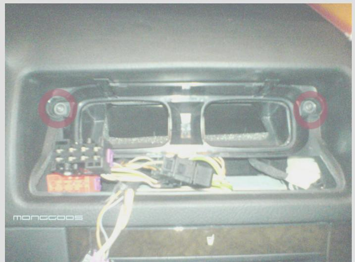
Auch hier wieder das alte Spiel, erst das Lüftungsgitter entfernen, nur diesmal nicht um an Schrauben zu gelangen sondern um besser die Düse auszuhebeln. Dazu benötigen wir jetzt das Messer oder einen andern flachen und stabilen Gegenstand, der nicht zu kurz sein sollte. Mit diesem hebt man nun die äußeren Haltenasen der Lüftungsdüse raus und zieht die Düsen aus dem Armaturenbrett.
