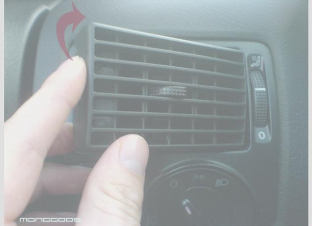
Nun entfernt man den Drehschalter für die Scheinwerfer. Dazu drückt man ihn nach hinten und stellt ihn auf die Standlichtfunktion. Nun kann man ihn zu sich hin rausziehen. Hinter dem Lüftungsgitter und dem Schalter verbergen sich zwei TORX – Schrauben die nun problemlos entfernt werden können.
