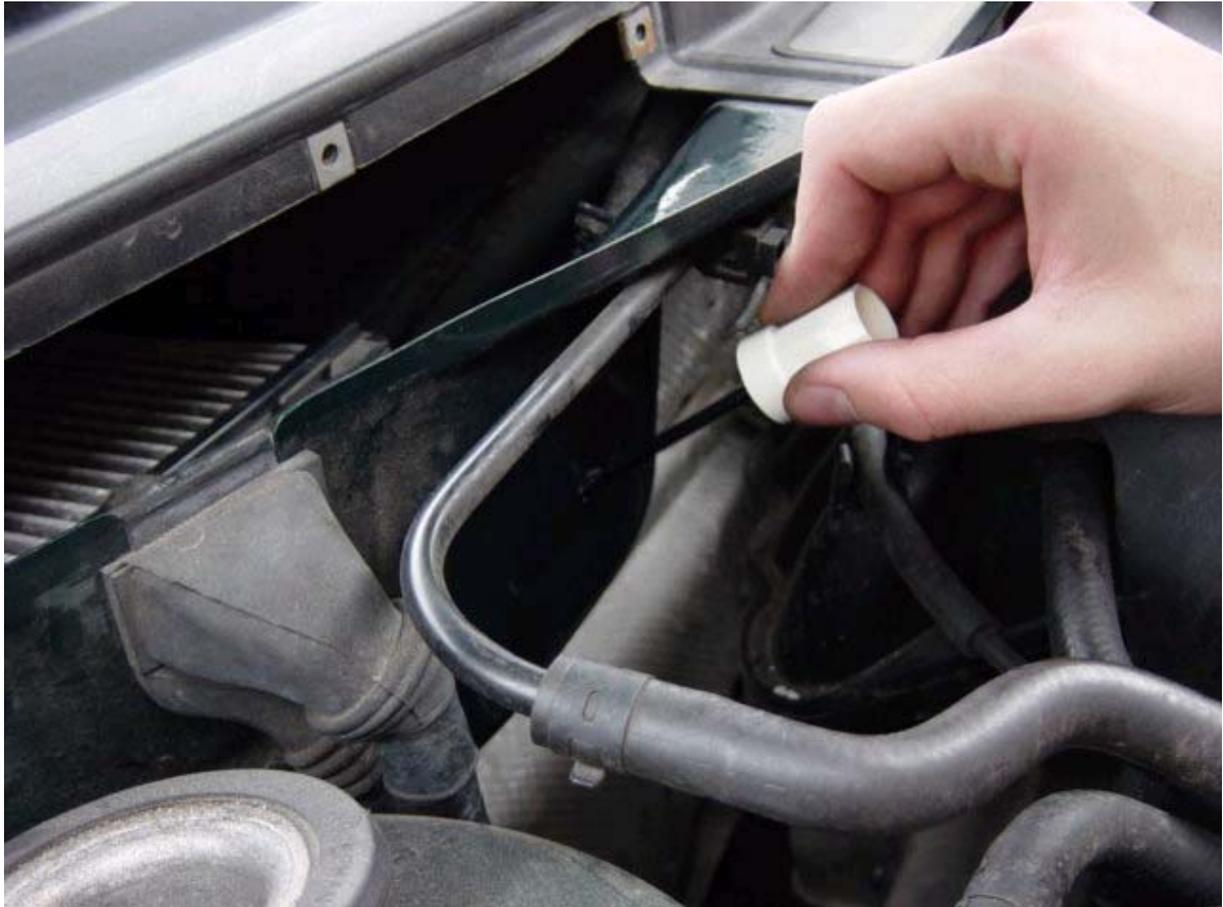
4. Jetzt kann man den einen Teil des Shocksensorgehäuses an der Karosserie festschrauben.
