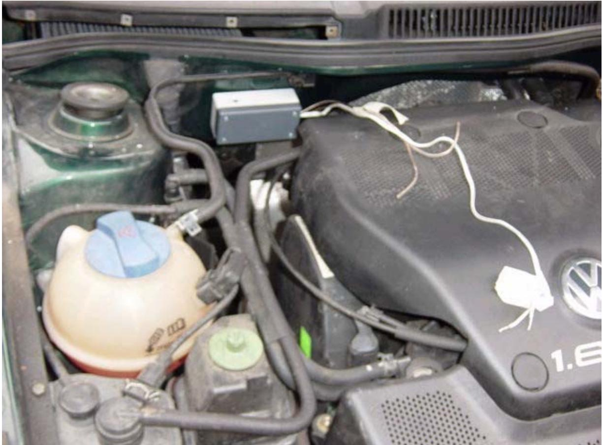
6. Jetzt werden die Kabel die beim Sensor dabei sind mit längeren Kabeln verlötet (empfohlen) oder mit Schnellverbindern oder Lüsterklemmen verbunden.
