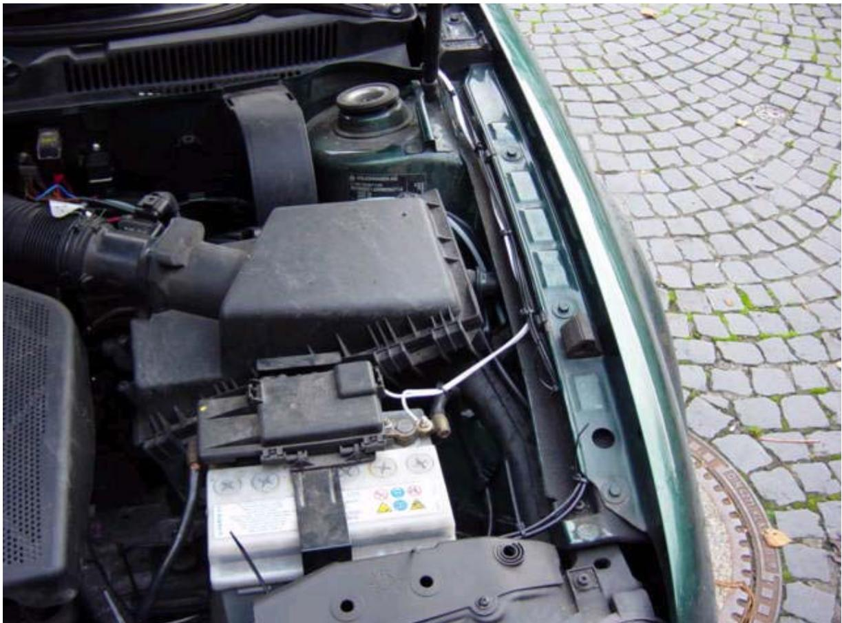
8. Die Kabel zum Motorhaubenkontakt werden ebenfalls angelötet oder mit Schnellverbindern verbunden.
