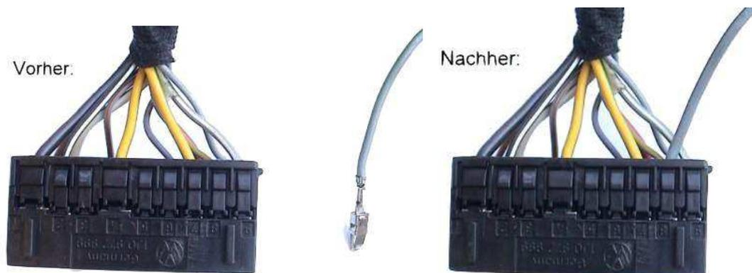
Jetzt müsst ihr an die Rückseite des Sicherungsträgers. Dazu den Sicherungsträger abschrauben und die Plastikabdeckung entfernen. Die weiße Leitung vom Relais klemmt ihr mit der Stromklemme an die weiße Leitung der Sicherung S18. Die graue Leitung vom Relais klemmt ihr auf die gleiche Weise an die graue Leitung der Sicherung S3.
