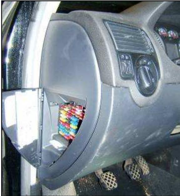
Abb. 4 Sicherungskasten
