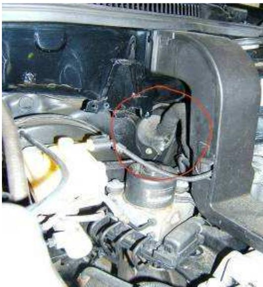
Abb. 3 Kabeldurchgang an der Spritzschutzwand
