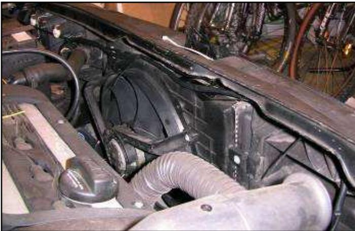
Abb. 14 Kabelverlauf über dem Kühler
