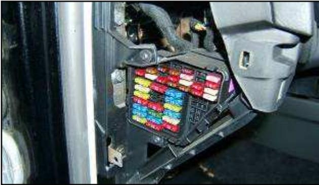
**Abb. 8 Sicherungskasten verschraubt**
