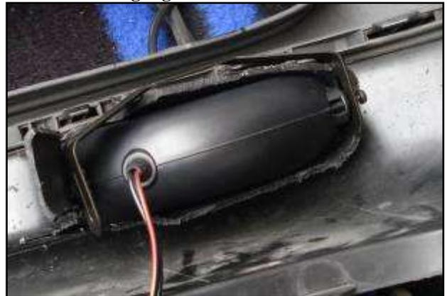
Abb. 25 Befestigung mit Bügel
