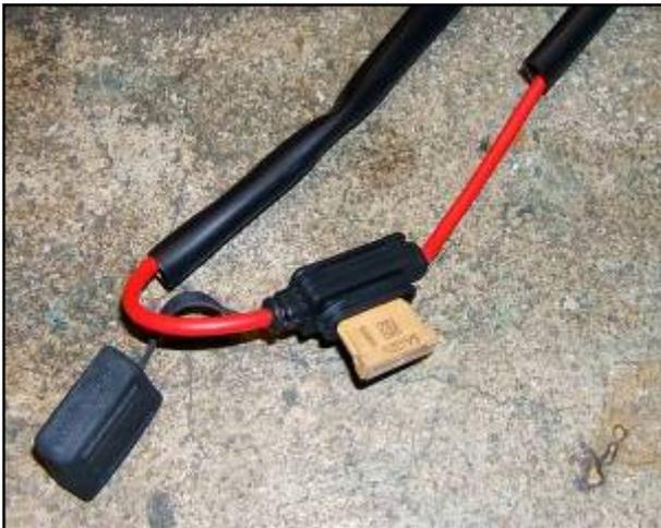
Abb. 1 Sicherung im Sicherungshalter
