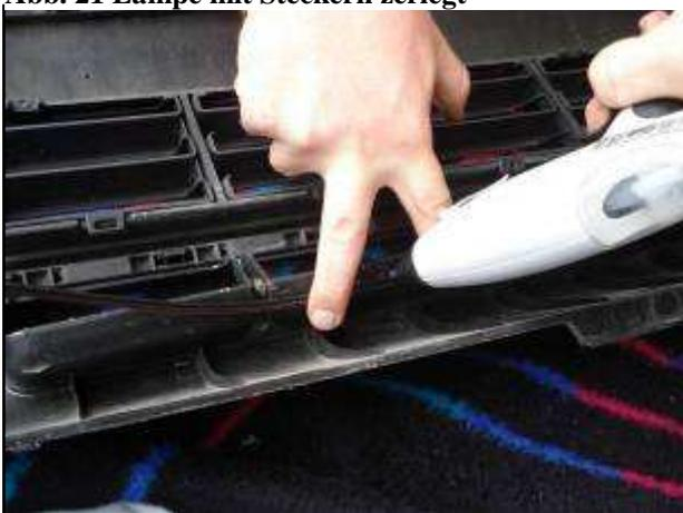
Abb. 22 Kabel mit Heißkleber fixiert
