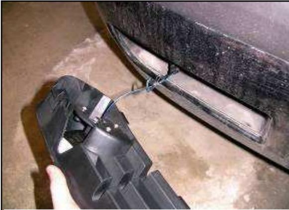
**Abb. 18 TFL eingesteckt fertig zum Einbau**
