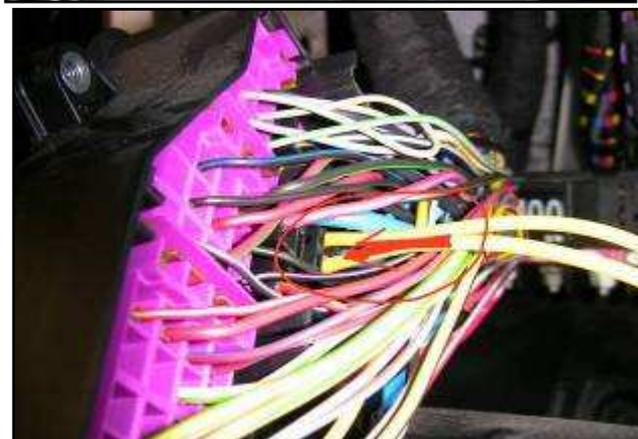
**Abb. 11 Die neuen Pins werden eingesteckt**
