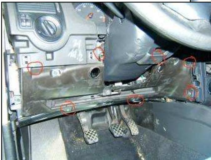
Abb. 6 Verschraubung innere Verkleidung
