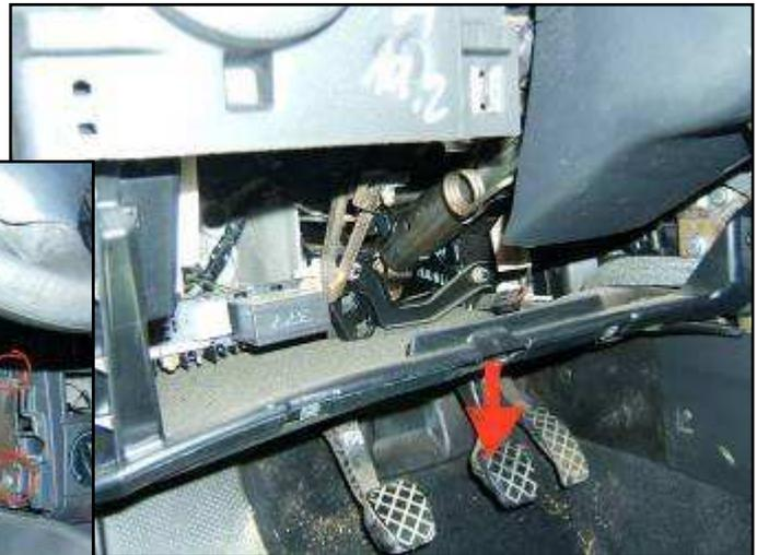
Abb. 7 Entfernen der unteren Verkleidung
