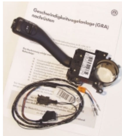
Der GRA-Bausatz ET-Nr. 1J0 998 527 für den TDI passt auch als Basis beim Benziner
