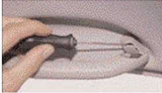
2. Griff nach unten halten und beide Schrauben mit Torx- oder Kreuzschlitzschraubendreher herausdrehen.
