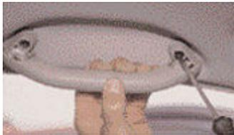
3. Das Brillenfach anstelle des Haltegriffs einsetzen und mit den selben Schrauben an der Dachsäule anschrauben.
