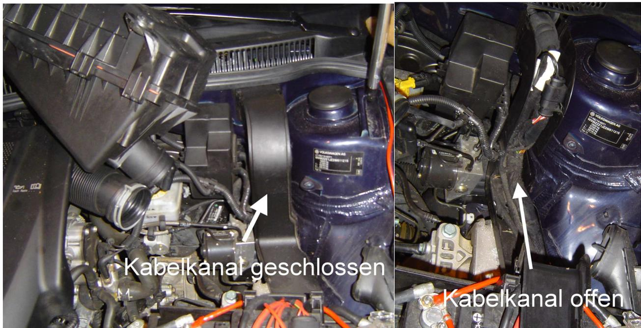
So ziemlich in der Mitte dieses Kanals ist ein kleines Loch durch welches ihr den Kabelstrang für den vorderen Niveausensor durchstecken müsst. Um jetzt weiter zu verlegen schraubt ihr erstmal das linke (Fahrerseite) Rad ab.
