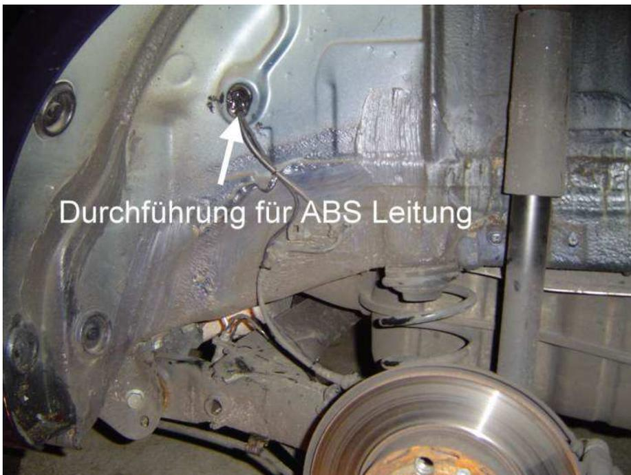
Schneidet mit einem spitzen Gegenstand ein kleines Loch in diese Durchführung und führt den Kabelsatz dort hindurch.
