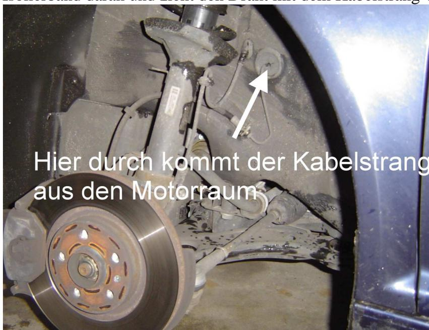
Jetzt müsst ihr die untere Schraube des Stabilisators lösen an welcher der Halter für das Gestänge Niveausensor VA befestigt wird.
