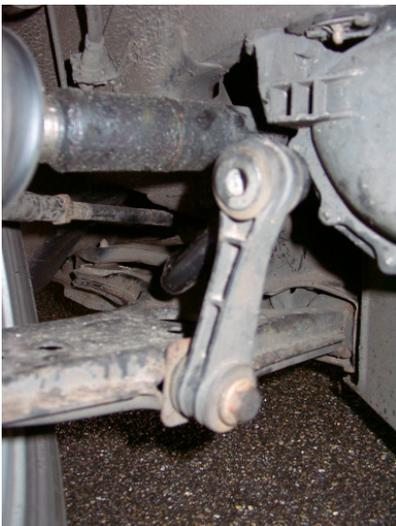
auf dem Bild der V6 Stabi an den kurzen Koppelstangen verschraubt
