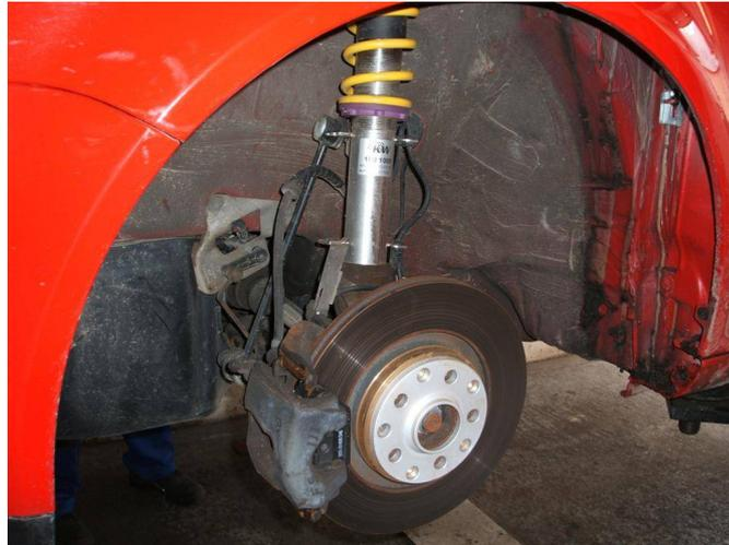
hier mal 2 Bilder vom KW Gewinde - dort siehst du mal nen V6 Stabi der unter der Antriebswelle entlang geht und mit der V6 Koppelstange am Federbein verschraubt wird...
