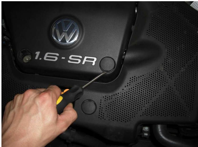
Nachdem ihr das gemacht habt könnt ihr die 7 Muttern die darunter zum Vorschein gekommen sind mit Hilfe einer Ratsche und einer 10er Nuss lösen! Eine Mutter ist nicht unter einer Blende, sondern direkt sichtbar auf der linken Seite der unteren Abdeckung (Bild 2)
