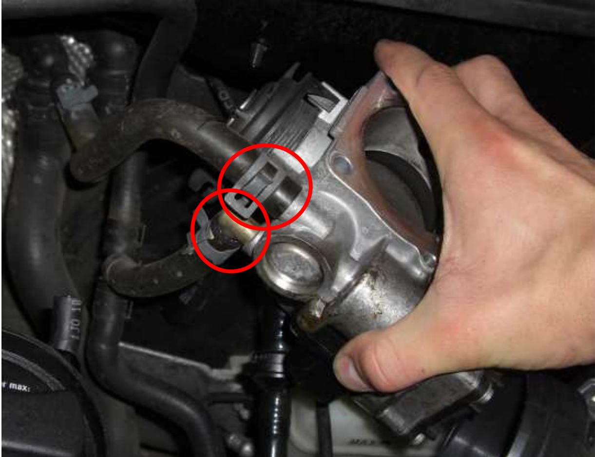
Nun kann mit dem Entfernen von grobem Dreck begonnen werden. Einfach mit dem fusselfreien Lappen vorsichtig Klappe und Aludruckgussgehäuse von innen reinigen:
