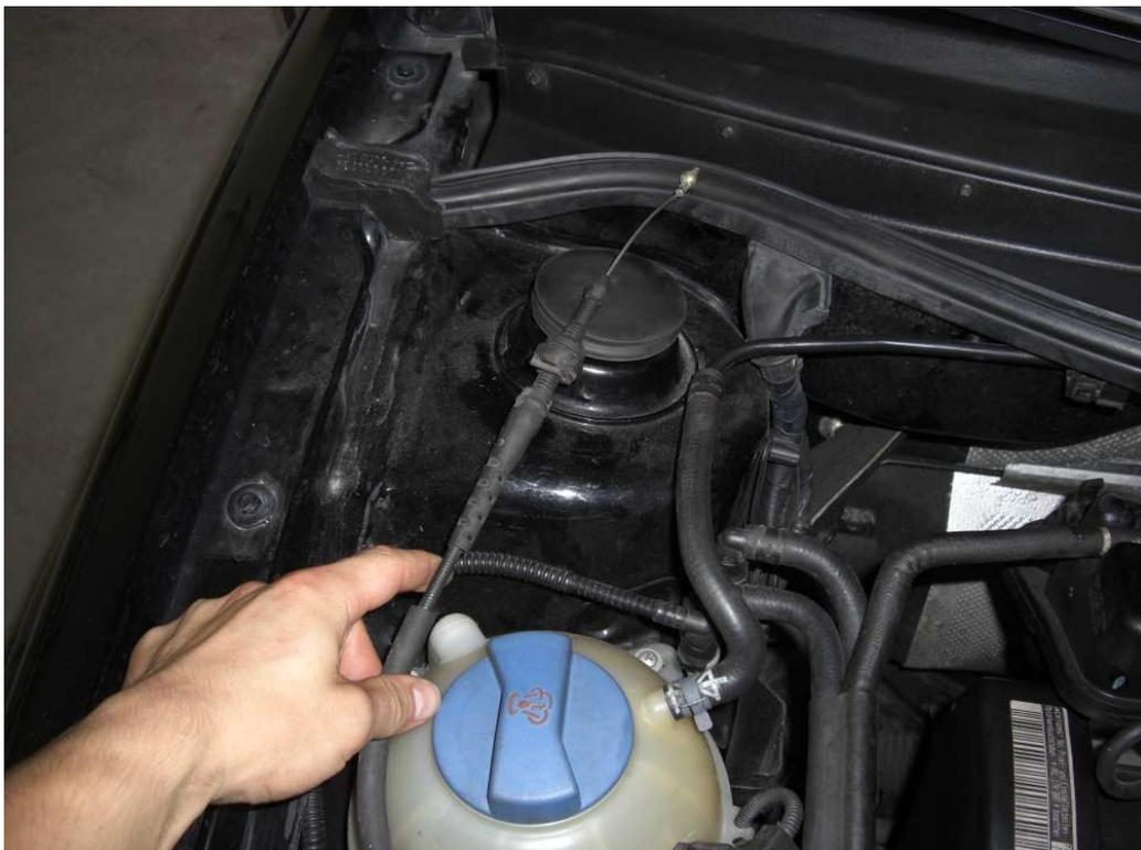
Anschließend müsst ihr alle Schlauchverbindungen die zum Luftfilter sowie zum Aktivkohlefilter führen lösen und entfernen:
