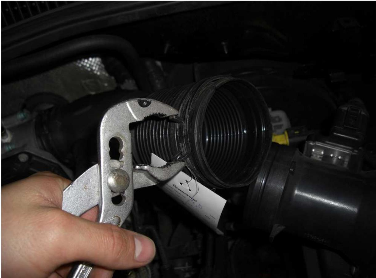
Jetzt noch den kleineren Schlauch von der Motorentlüftung lösen und mit einem flachen Schlitzschraubenzieher (☹) vorsichtig vom Ventildeckel runterschieben:
