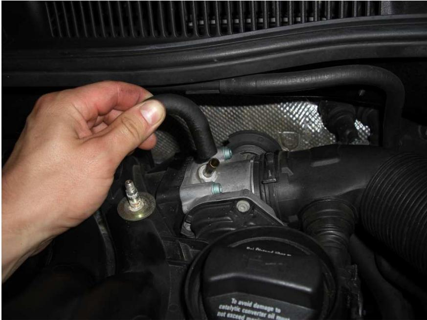
Die Schlauchschellen vorsichtig mit einer Rohrzanze zusammendrücken und dabei den Luftschlauch mit einer drehenden Bewegung von der Drosselklappe sowie vom Luftmassenmesser/Luftfilterkasten abziehen:
