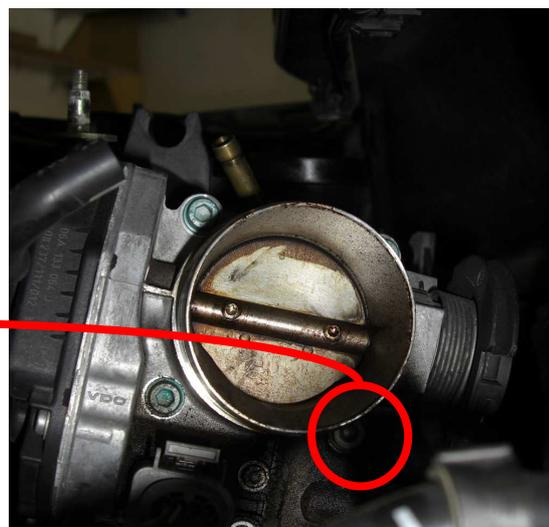
Jetzt könnt ihr die Drosselklappe vom Saugrohr abnehmen. Achtet bei allen folgenden Arbeiten auf die beiden Kühlwasserschläuche! Diese müssen nämlich **nicht** gelöst werden, da die Reinigung so genauso gut funktioniert und beim Abziehen nur unnötig Kühlwasser davonläuft.
