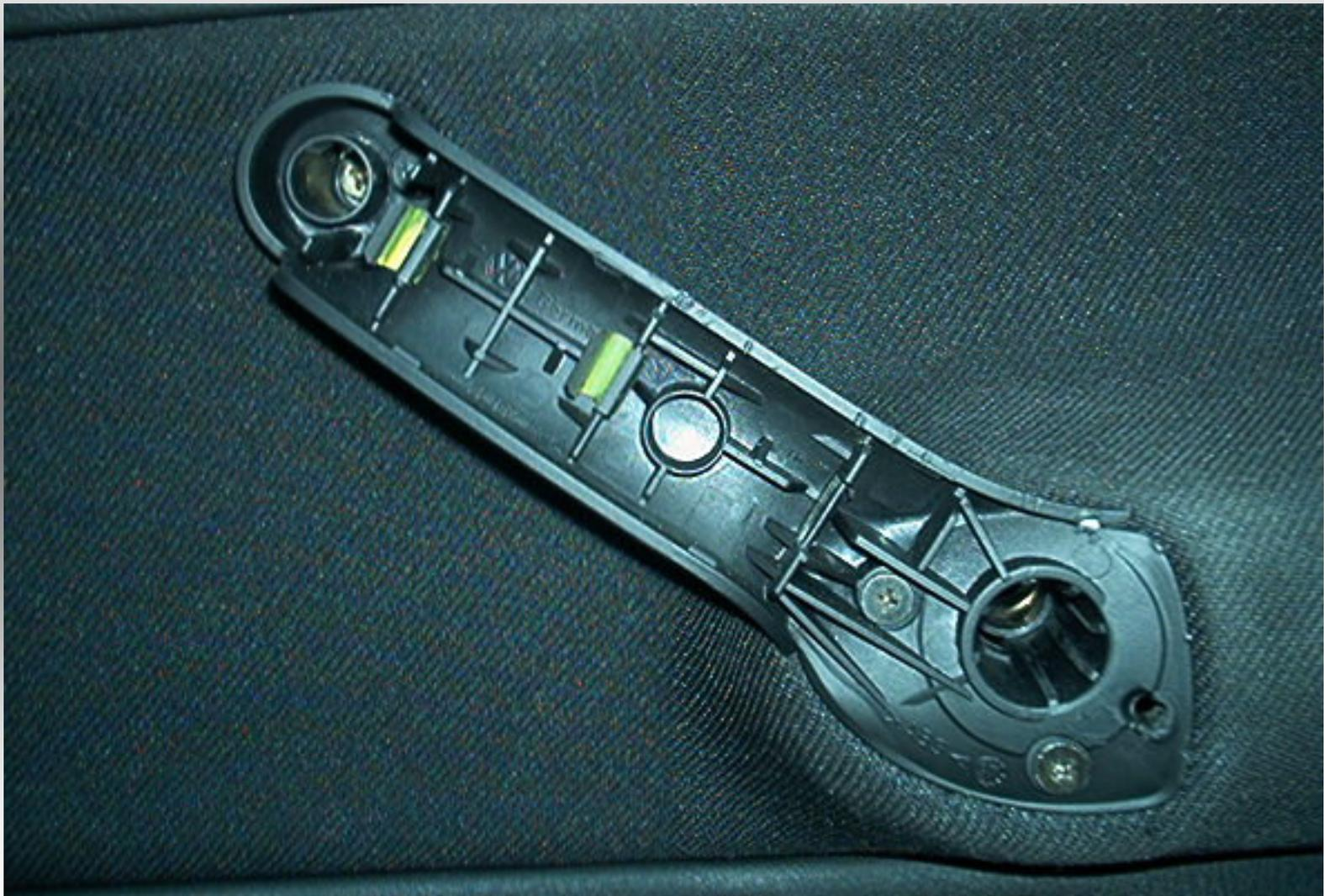
Entfernung der 5 Schrauben mittels Kreuzschlitzschraubendreher
