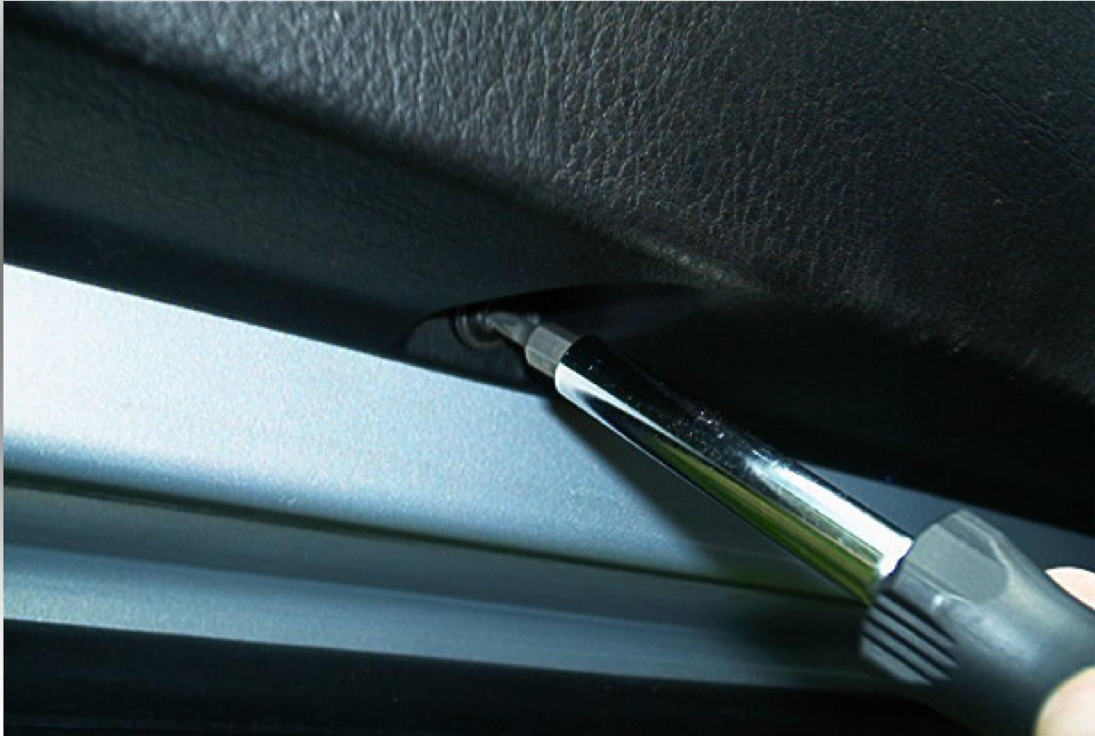
**Schraube an der Verkleidung direkt unter dem Hochtöner entfernen mit
