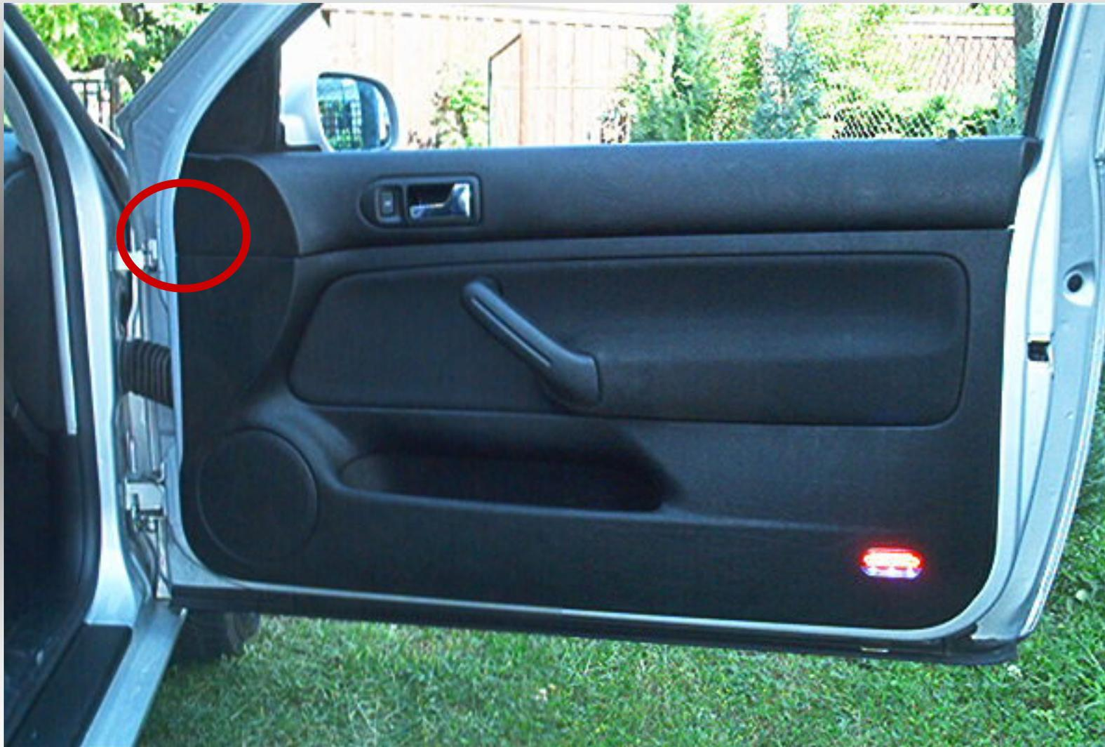
**Türleuchten heraushebeln, dies geschieht mittels Schlitzschraubendreher**
