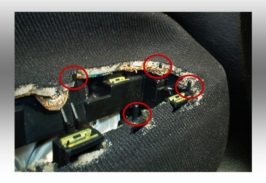
Anschließend ganze Türverkleidung mit sanfter Gewalt nach oben abziehen, dabei aber vorsichtig sein wegen weiterer Kabel insbesondere Spiegelverstellung
