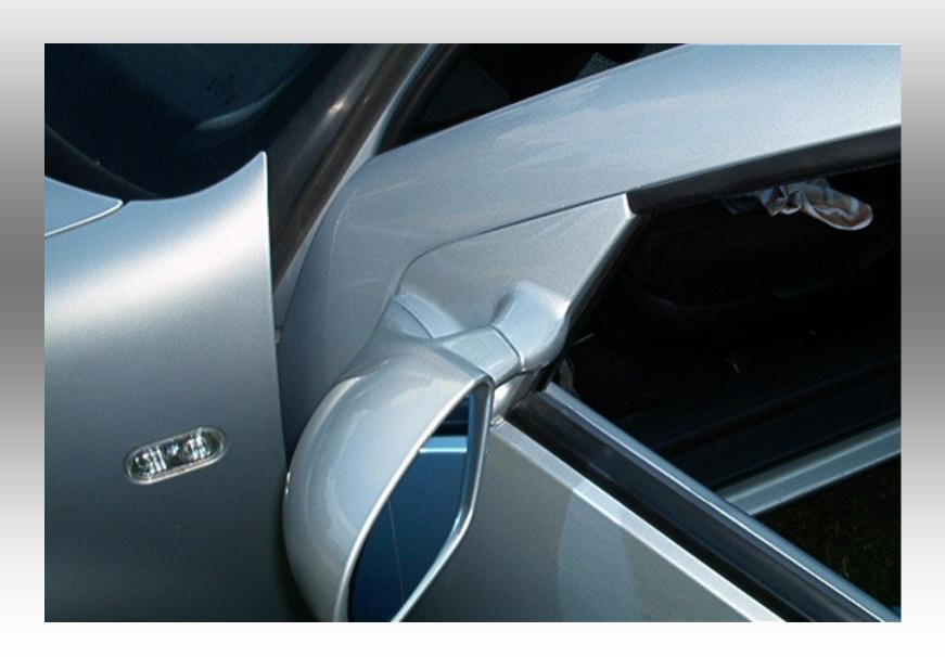
Montage erfolgt wie Demontage nur in umgekehrter Reihenfolge. Wichtig! Beim Anbau auf den Zugmechanismus der Türpins (Zentralverriegelung) achten. Er muss wieder in die Aufnahme eingeführt werden.
