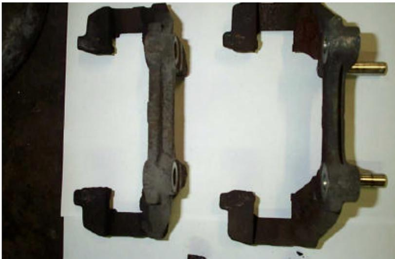
**Bremse alt – Größenvergleich Bremssattel alt / neu**
