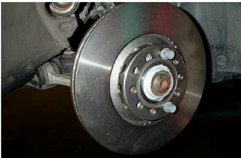
**Bremse neu – montierte Bremsscheibe 312mm**
