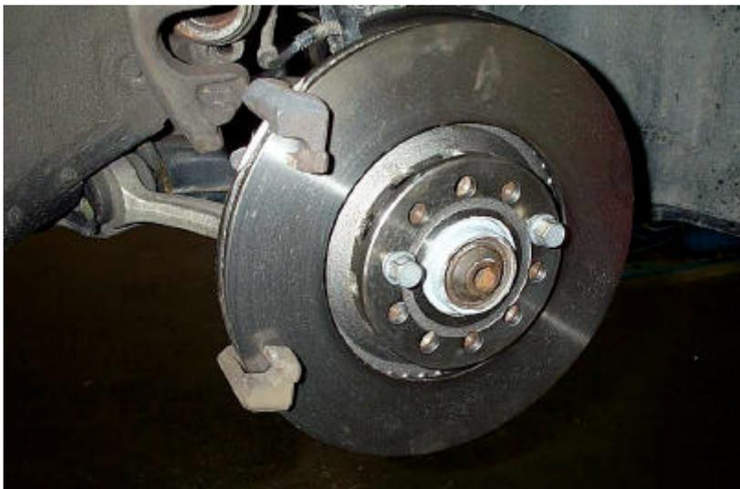
**Bremse neu – montierte Bremssattelträger**
