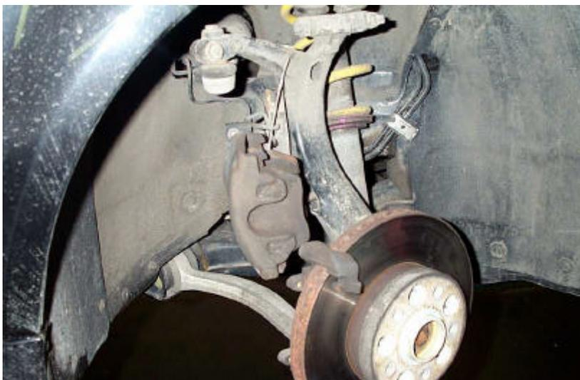
**Bremse alt – Bremssattel und Klötze entfernt**
