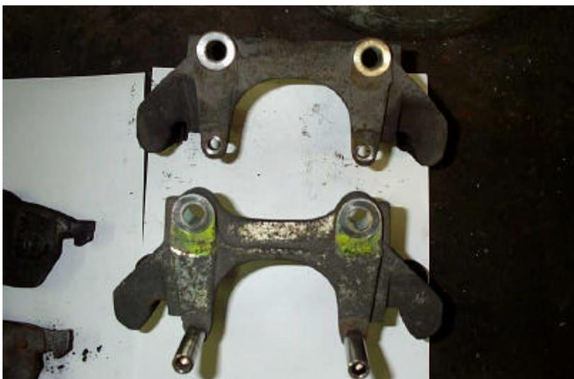
Bremse alt – Grössenvergleich Bremssattel alt / neu
