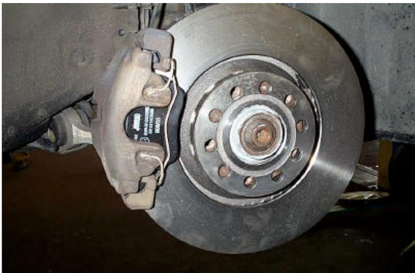
**Bremse neu – montierte Sättel, Beläge und Haltefeder**
