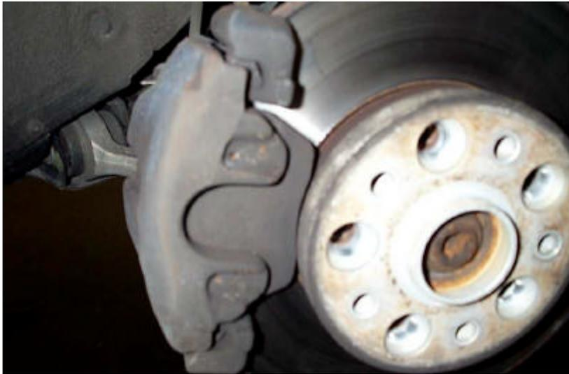
**Bremse alt mit entfernter Haltefeder**
