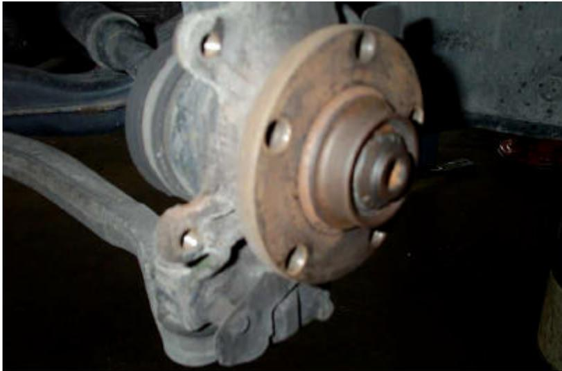
**Bremse alt – Bremsscheibe entfernt**
