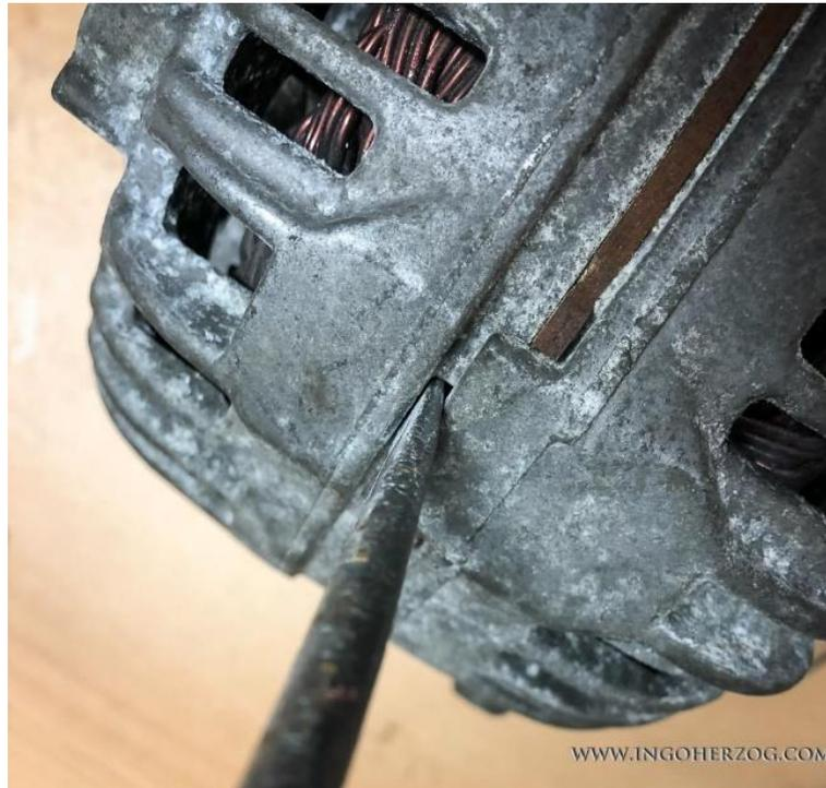
*Abbildung 10: Mit einem großen Schraubendreher kann man in den Spalten des Gehäuses gut hebeln. Aber Vorsicht: Nicht die inneren Kupferwicklungen beschädigen*
