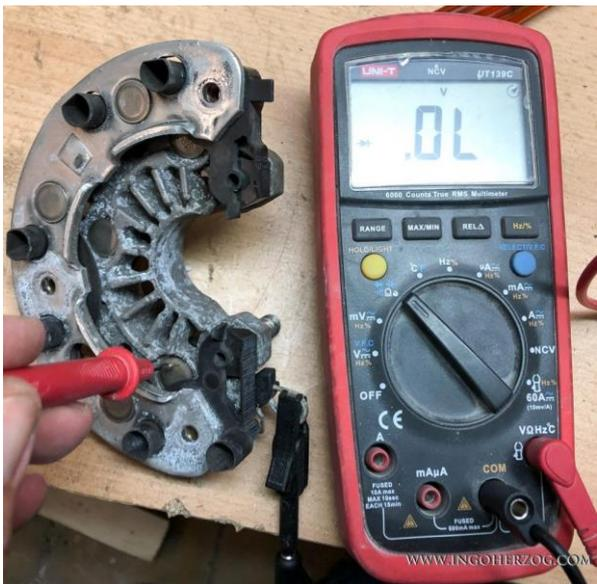
Abbildung 31: Hier ist der Minuspol mit dem Ringschuh verbunden und mit dem Pluspol werden die Dioden gemessen
