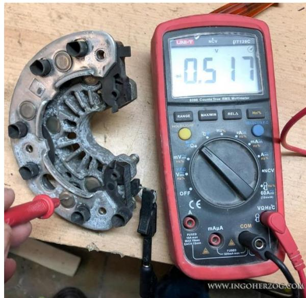
Abbildung 32: : Im linken Bild sperrt die Diode, hier lässt der äußere Ring Spannung durch.
