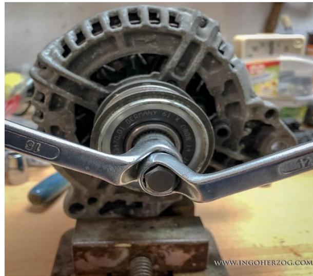
Abbildung 9: Zum Lösen des Freilaufes muss der Freilauf nach links und die Welle nach rechts gedreht werden
