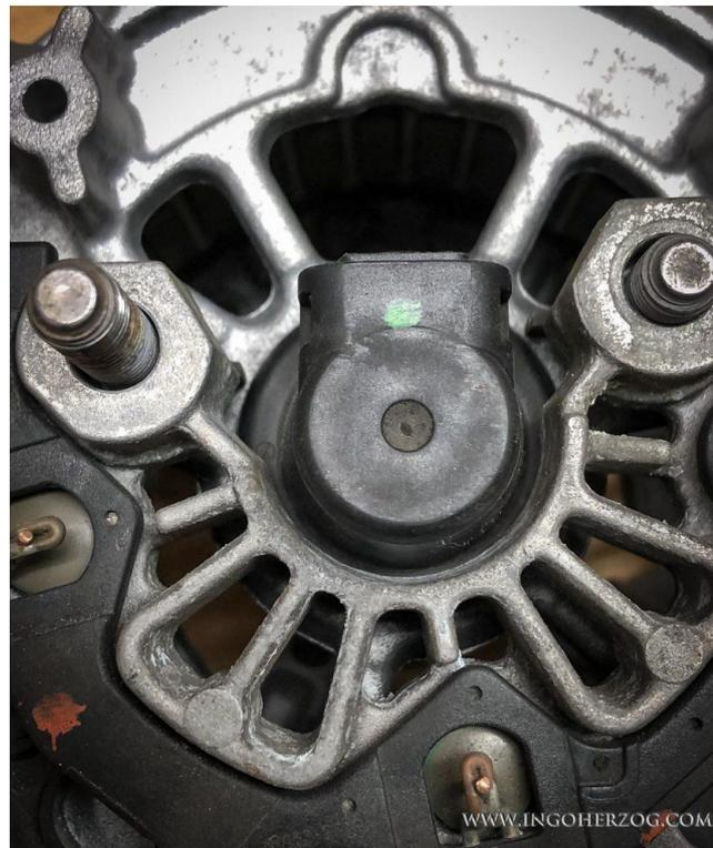
Abbildung 58: Zum Schluss noch die Abdeckkappe ausrichten, so dass die Öffnung genau mittig in das fehlende Drittel schaut.
