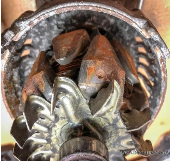
*Abbildung 12: der ziemlich stark angerostete Rotor*
