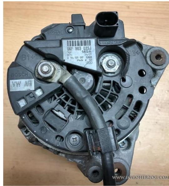
Abbildung 2: Hier sieht man die Teilenummer. Das J am Ende weist ihn als Generator für einen Audi A4 aus. Diese TN ist inzwischen entfallen und wurde durch die gleiche TN mit der Endung F ersetzt.
