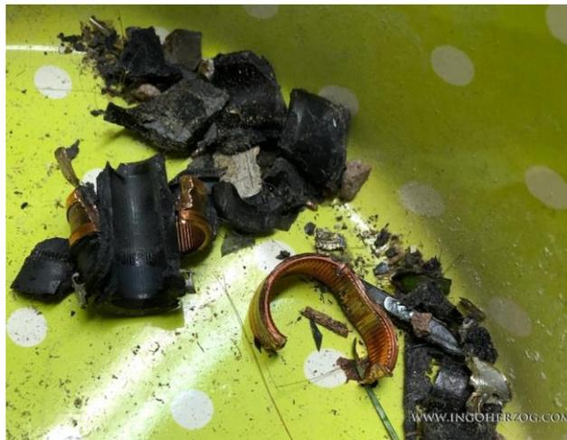
Abbildung 26: Das was von dem Schleifring übrig blieb
