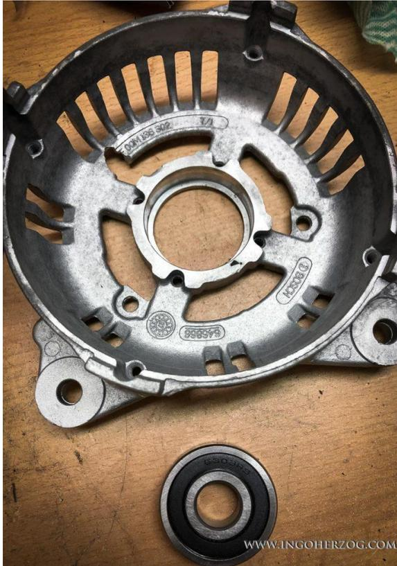
Abbildung 53: Das große Lager kommt in die Gehäuse-hälfte, die später zum Freilauf zeigt.
