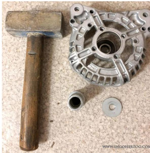
*Abbildung 17: Eine passend große Unterlegscheibe und ein passendes Werkzeug zum Ausschlagen des Lagers hilft dem „kleinen“ Fäustel ungemein*
