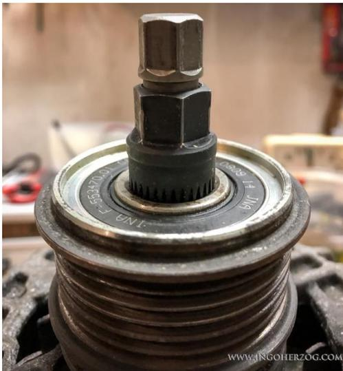
Abbildung 8: Das Werkzeug korrekt angesteckt
