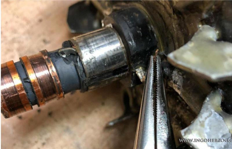
Abbildung 24: Die Kabel mit einer kleinen Zange von den Metallplättchen trennen
