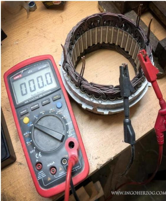
Abbildung 35: Bei zueinander gehörenden Kupferenden des Stators sollte der Widerstand sehr gering sein ...
