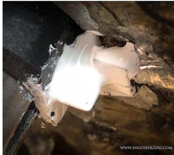
Abbildung 48: Zum Schluss habe ich die Kontaktflächen noch mit Acrylfarbe zur Isolierung bestrichen.
