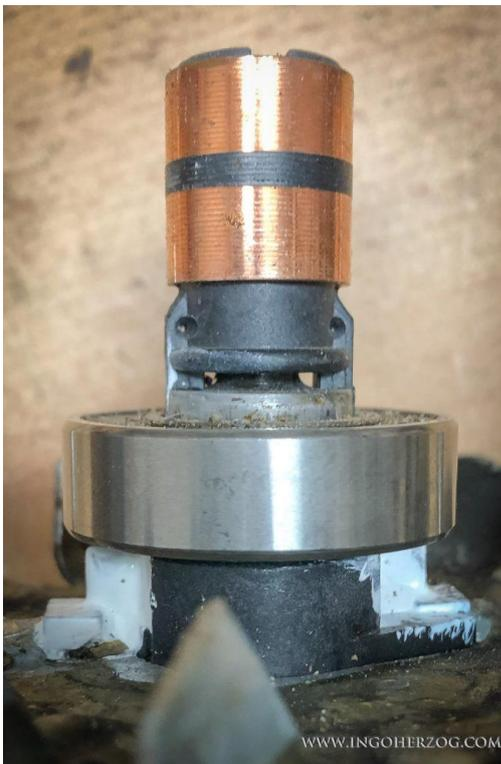
Abbildung 57: Auf der anderen Seite musste mit leichten Hammerschlägen nachgeholfen werden, aber wirklich nur leichten
