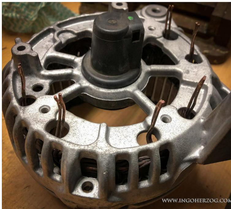
Abbildung 49: Die Kabel schauen durch das Gehäuse. ACHTUNG: Die Hülse in der Mitte sitzt noch nicht richtig!
