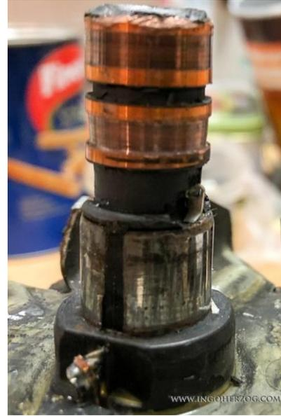
Abbildung 19: Die Hülse der Schleifringe ist ziemlich demoliert, stört aber nicht, denn sie wird eh getauscht
