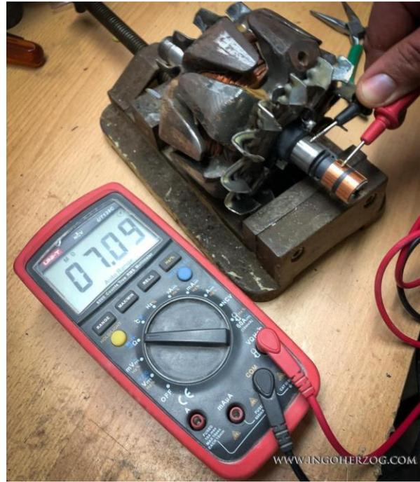
Abbildung 38: Von Schleifring zu Metalloberflächen sollte kein oder zumindest ein sehr hoher Widerstand zu messen sein, hier über 7 Megaohm.
