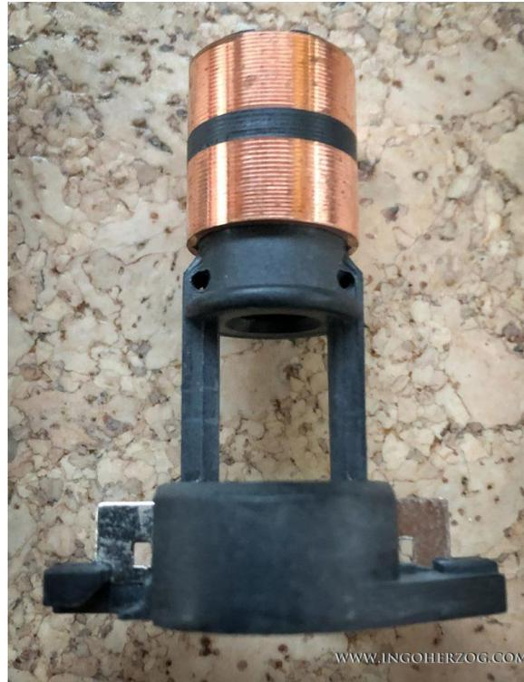
Abbildung 43: ...und der neue Schleifring.
