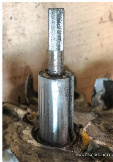
Abbildung 28: Hier die Welle geputzt und geschliffen
