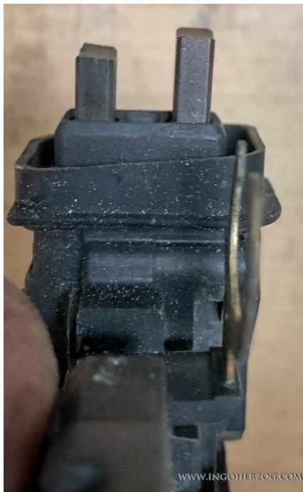
Abbildung 5: unterschiedlich abgenutzte Kohlen am Regler
