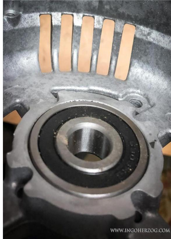
Abbildung 54: Das Lager muss bündig mit dem Gehäuse sein.
