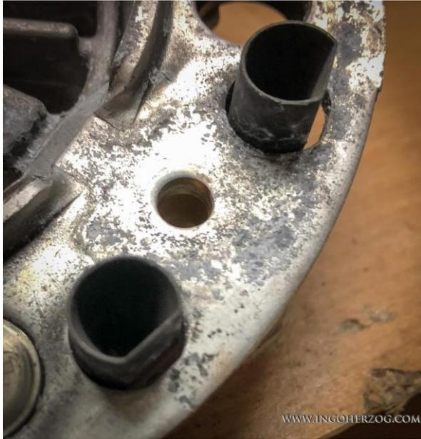
Abbildung 50: Hier sieht man die Kabeldurchführungen aus Kunststoff an der Diodenplatte
