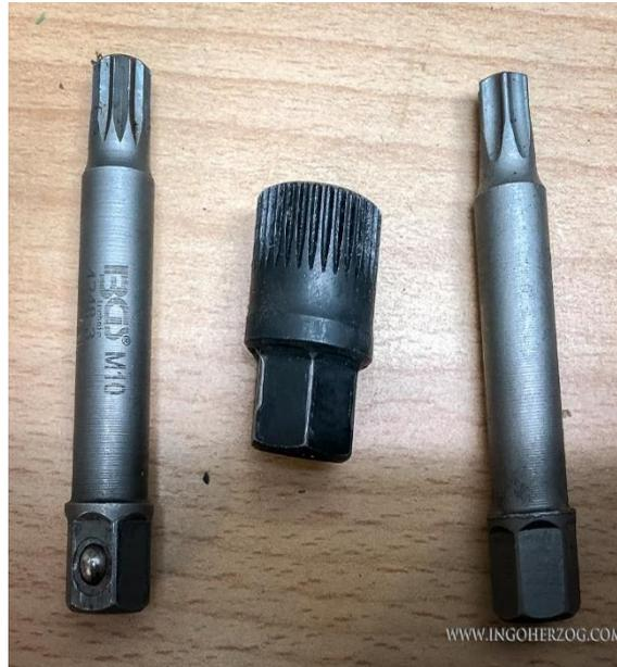
Abbildung 7: Das Spezialwerkzeug zum Lösen des Freilaufes
