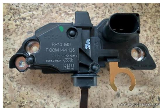
Abbildung 42: Der neue Regler, die Teilenummer ist gut zu lesen
