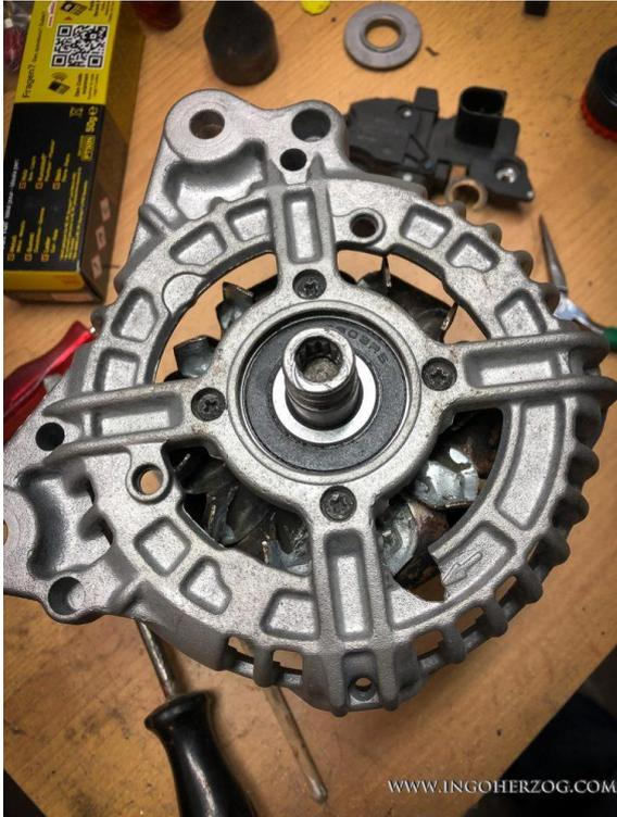
Abbildung 55: Durch das Einfrieren rutschte bei mir das Lager einfach so auf die Welle...
