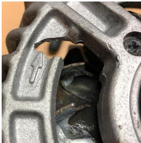
Abbildung 16: Bei mir war das Lager sehr fest, so fest, dass beim ersten Versuch ein Teil aus dem Gehäuse herausbrach.
