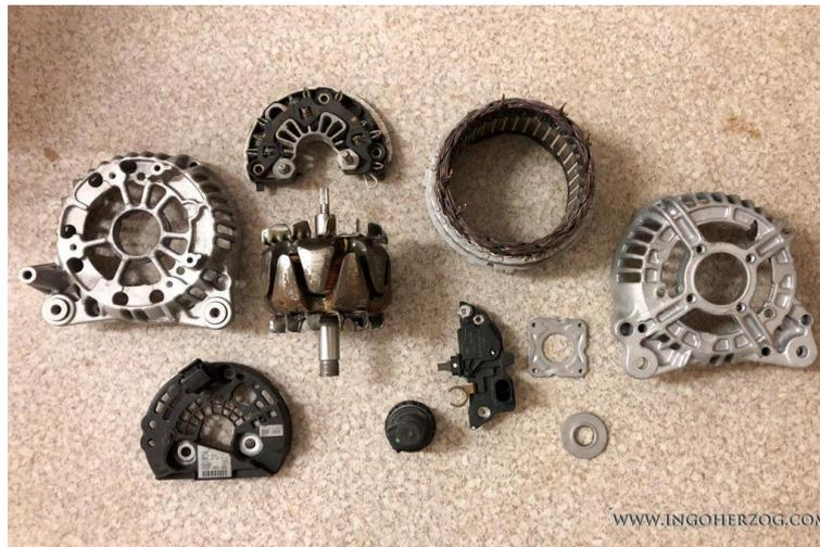
*Abbildung 30: Der Generator zerlegt, alle Teile schön aufgereiht.*
