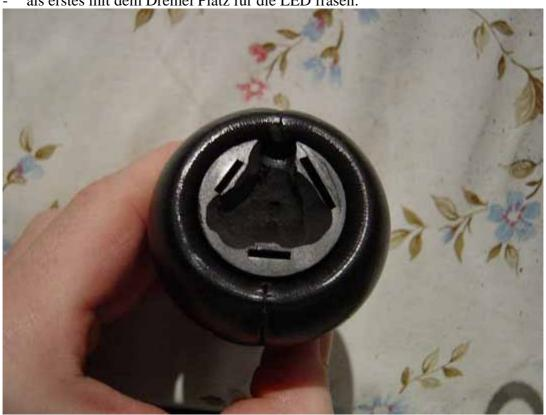
dann an der Seite wo kein Spalt für das Schema ist, in Höhe der Naht ein senkrechtes Loch durch den Knauf bohren und die Kabel durchstecken:
