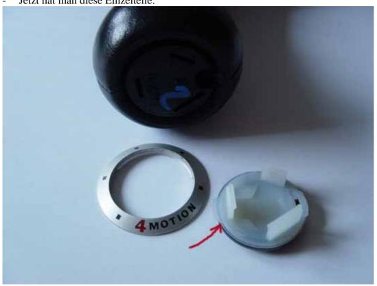
das Schema ist auf eine Trägerplatte geklebt und kann durch vorsichtiges runterhebeln an den Nasen (siehe Pfeil) abgelöst werden
