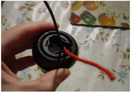
nun die LED mit dem Widerstand (wenn nötig) und den Kabeln verlöten und mittig in den Knauf einsetzen, unbedingt prüfen ob die LED senkrecht leuchtet, damit nachher eine gleichmäßige Ausleuchtung vorhanden ist
