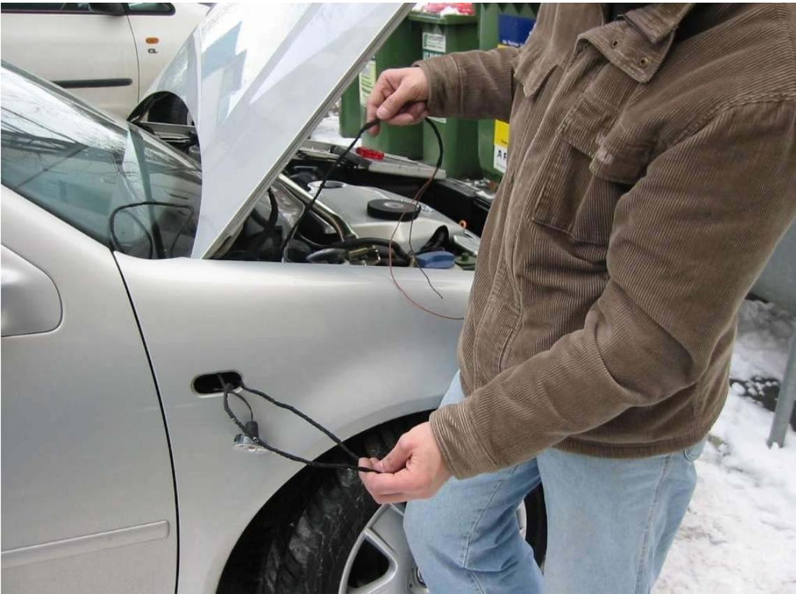
Kabelstrang nun unter dem Wasserabweiser bis rüber zur Wasserkastenabdeckung legen und zwischendurch immer etwas mit Kabelbindern an den bestehenden Kabelsträngen dazu binden.
