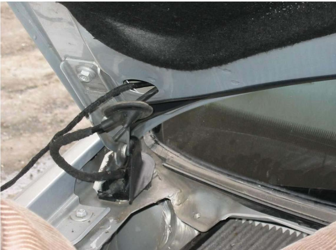
Nun nimmt man am Besten den Seitenblinker raus, da die Leitung neben dem Kotfluegel unter den Wasserabweiser verlegt werden muss (Abnahme des Wasserabweiser und Ausbau des Wischergestänges ist in meiner Anleitung zum Austausch des Wischergestänges erklärt).
