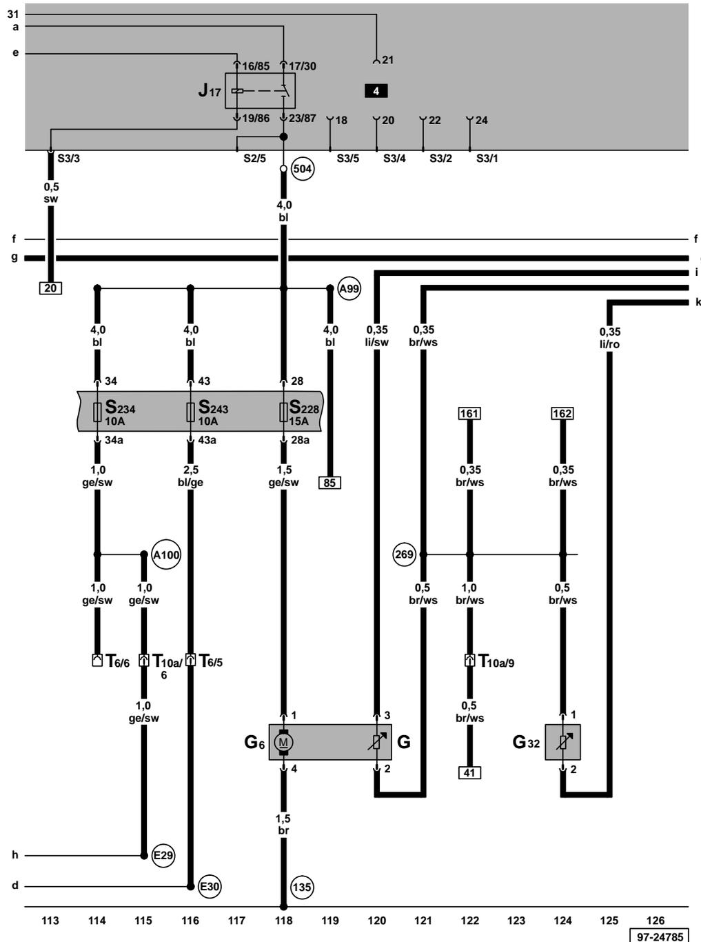
**Kraftstoffpumpe, Geber für Kraftstoffvorratsanzeige, Geber für Kühlmittelmangelanzeige**
