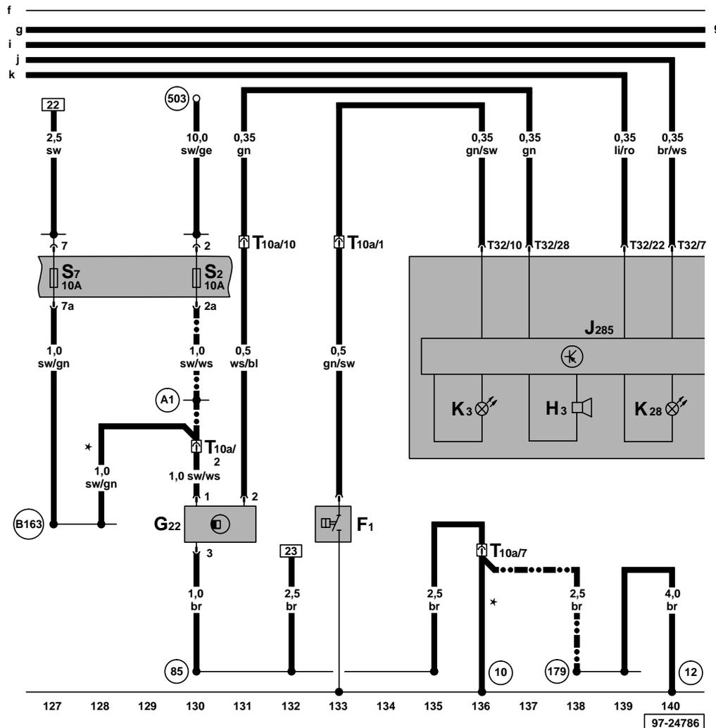
Schalttafeleinsatz, Kühlmitteltemperaturanzeige, Kraftstoffvorratsanzeige, Drehzahlmesser, Geschwindigkeitsmesser, Anschluß für Eigendiagnose, Kontrolllampe für Generator
