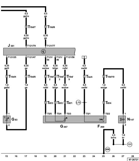
Steuergerät für Simos, Geber für Kühlmitteltemperatur Kühlerausgang, Potentiometer für Drehknopf Temperaturwahl, Schalter für Stellung Temperaturklappe, Zweiwegeventil für Kühlmittelabsperrventil
