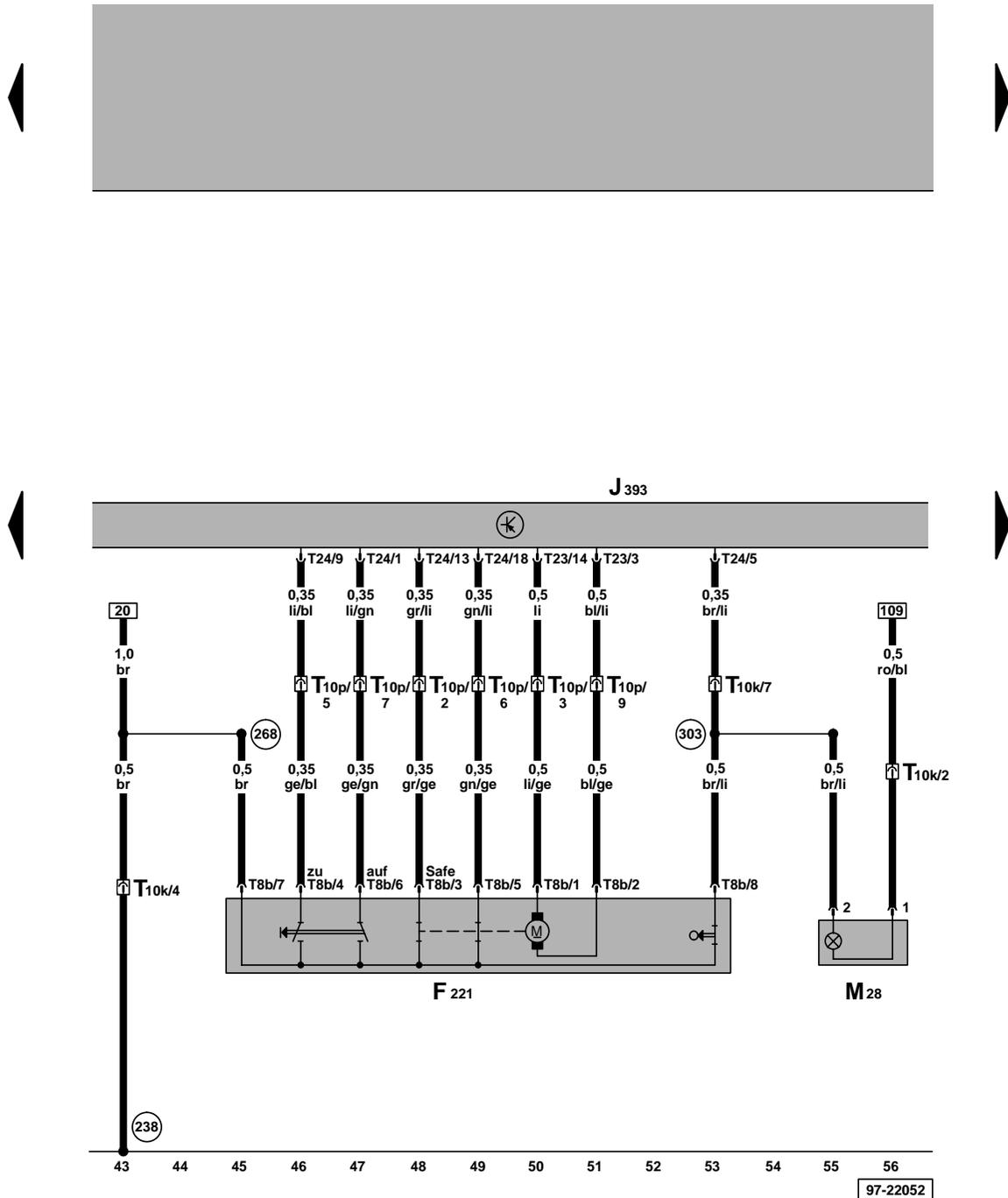
Zentralsteuergerät für Komfortsystem, Schließeinheit für Zentralverriegelung (hinten links)
