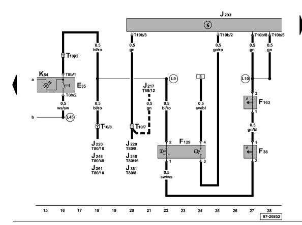
Steuergerät für Lüfter für Kühlmittel, Schalter für Klimaanlage, Druckschalter für Klimaanlage, Thermoschalter für Klimaanlage-Abschaltung, Außentemperaturschalter
