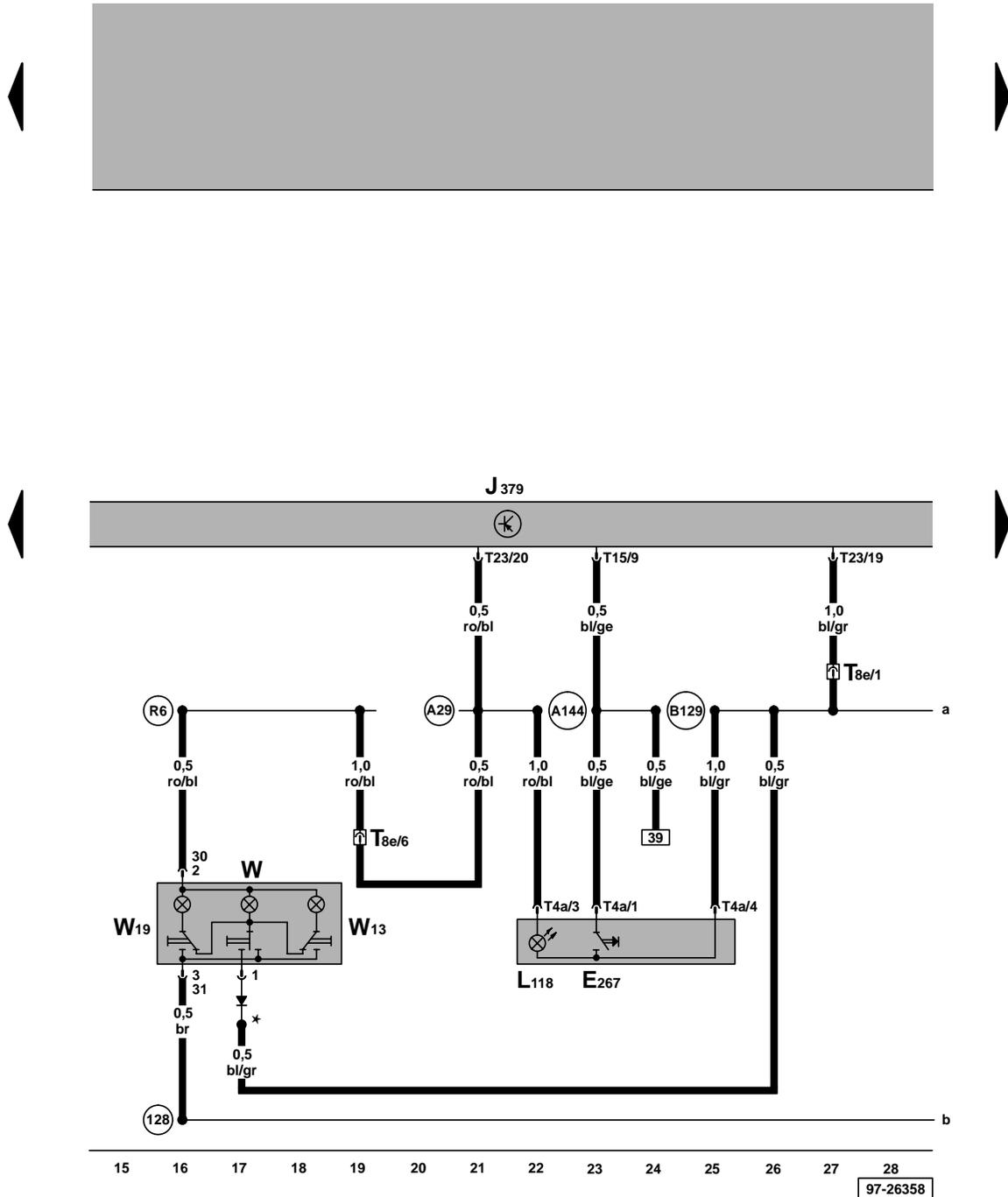
Steuergerät für Zentralverriegelung und Diebstahlwarnanlage, Sender und Sensor für Innenraumüberwachung, Leseleuchten hinten
