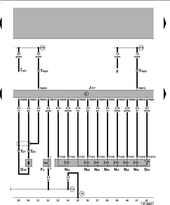
Steuergerät für automatisches Getriebe, Magnetventile, Geber für Getriebedrehzahl, Kick-down-Schalter, Geber für Getriebeöltemperatur
